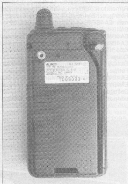
Vista trasera del DJ-S11T, mostrando la antena escamoteable alojada en un rebaje de la tapa posterior.
