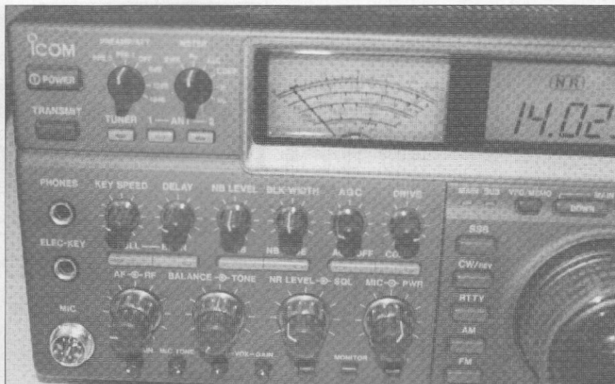
Lado izquierdo del panel frontal. Hay cantidad de mandos y habituarse a los mismos lleva su tiempo. En la parte superior izquierda se hallan los mandos de los preamplificadores y el conmutador de lecturas del instrumento. Debajo de los mismos se hallan los mandos del acoplador de antenas, uno por cada entrada de antena. Luego siguen los mandos de manipulación y a continuación los mandos del reductor de ruidos, CAG y compresor. En la parte inferior de la izquierda se hallan los mandos AF/RF, Equilibrio/Tono, NR o de nivel de reducción de ruidos y Silenciador, seguidos por los mandos de Ganancia de Micrófono y Potencia (PWR).
