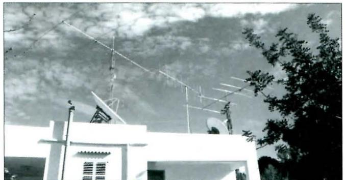
Las antenas para 20 y 10 metros. En el centro: la Yagi para 2 metros del enlace por radiopaquete.
