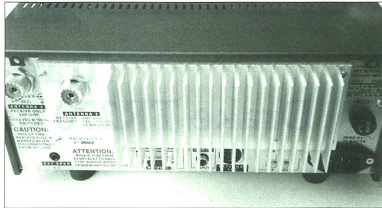
Vista posterior del TR270 en la que se distingue el amplio refrigerador, los dos conectores de antena y los conectores (ports) para ordenador (interfaces).
