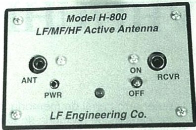
El Skymatch H-800 de LF Engineering es una antena activa que cubre desde 10 kHz hasta 50 MHz. Encerrada en una caja estanca, puede instalarse en el exterior y ser alimentado a través del cable coaxial que le une al receptor.
