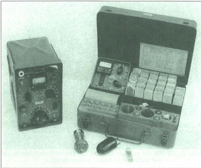
El acoplador automático de antena y la caja de recambios del RM-31. Véase el reducido tamaño de la válvula, delante a la derecha.
