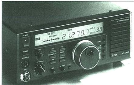
todas las bandas decamétricas con la máxima simplicidad de controles. Con una potencia ajustable entre 5 y 100 W en SSB, CW y FM con un módulo opcional (entre 5 y 25 W en AM) en todas las bandas y un receptor de cobertura continua entre 500 kHz y 30 MHz y una sensibilidad de 0,16 µV (con el preamplificador en servicio), e incluye un altavoz en el panel frontal para óptima inteligibilidad.
