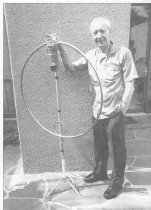
La antena de aro magnética, obra de Michel, XE1MD.
