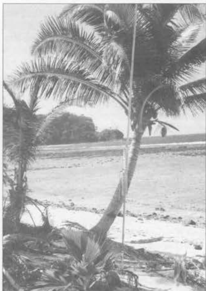
Antena vertical Butternut HF2V para bandas bajas, clavada en la arena de la playa, junto a la cabaña.
