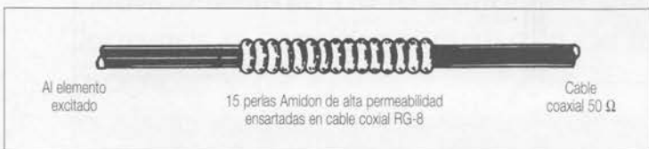
Figura 6. Balun para la adaptación 1:1.
