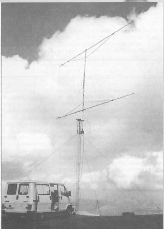
Instalación portable utilizada por Jorge, EA2LU, desde el monte Ortanzurieta a 1.567 SNM. Dos antenas Yagi 4218 de Cushcraft.
