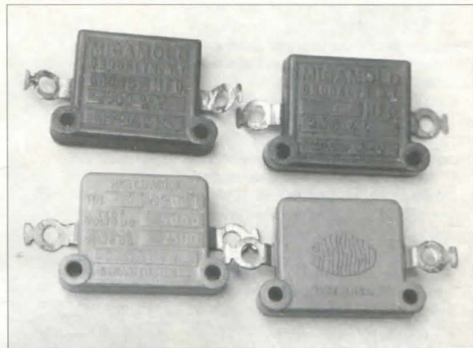
Figura 3. Vista detallada de los condensadores de alta tensión de las marcas Sangamo y Micamold, como los utilizados en el transmisor con válvula 35T. Estos componentes están rotulados con su tensión máxima (5.000) y su tensión de trabajo (2.500) ¡y tienen una magnífica apariencia de solidez!
