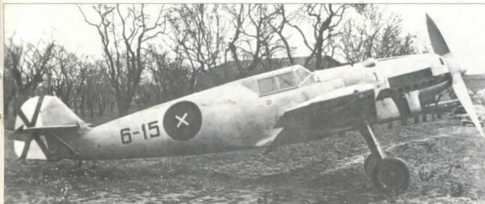
El caza Messerschmitt Bf-109-B, que se usó en la Guerra Civil española, no tenía el mástil de antena que se observa en otras unidades al servicio de la Luftwaffe . (Gerald Howson; Aircraft of the Spanish Civil War .)
