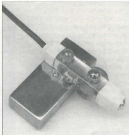
Foto 2. Versión todo-latón/QRP del Ne Ke fabricado por N9VKA. Los muelles de cinta laterales substituyen a las palancas de puntos y rayas. La tuerca de retención superior se puede aflojar a mano y la palanca del manipulador se puede alinear con la base para llevar el manipulador en el bolsillo o para operar de manera convencional (más detalles en el texto).
