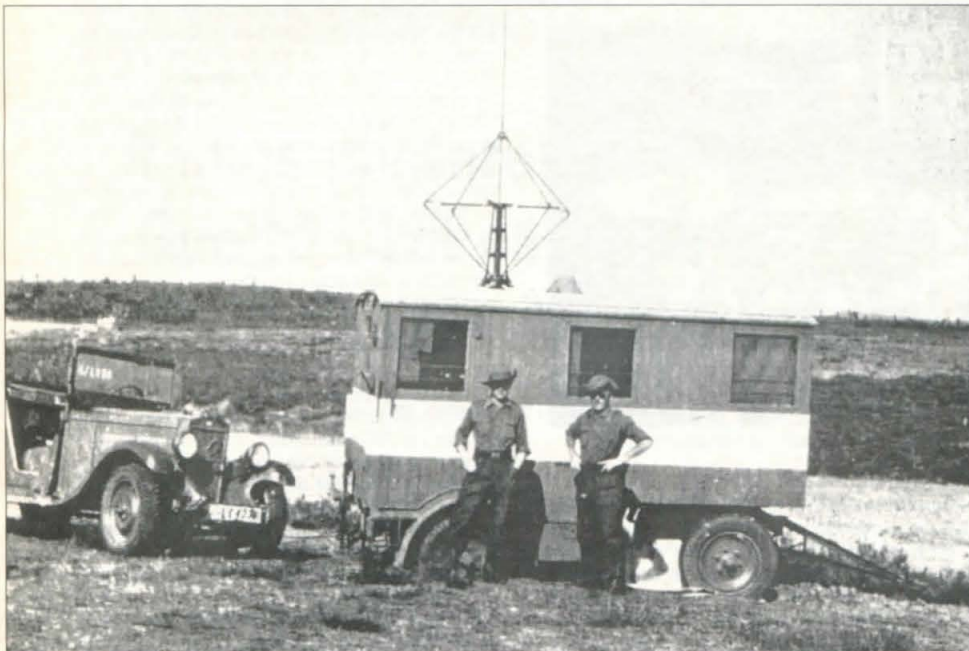
Estación de radiolocalización de un aeropuerto de la Legión Cóndor, instalada en un remolque.
