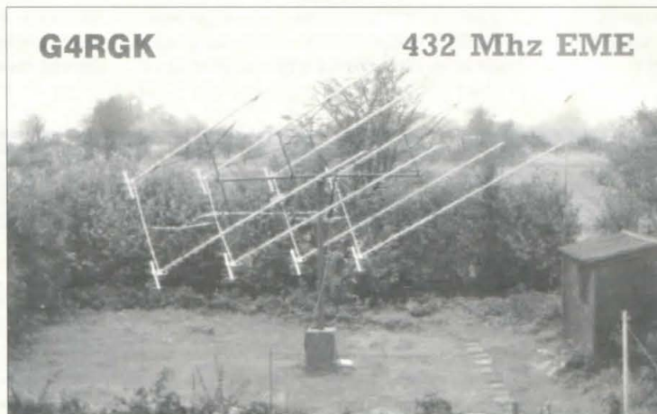
Compacta y «ecológica» instalación de antenas para RL, de David, G4RGK.
