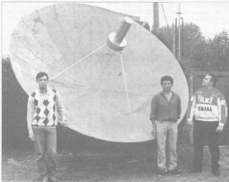
De izquierda a derecha: Marc, LU6DW, Willy, LU4DHD, y Dany, LU8EDR, posan frente a su disco parabólico para trabajar RL desde Argentina en la banda de 1.296 MHz.
