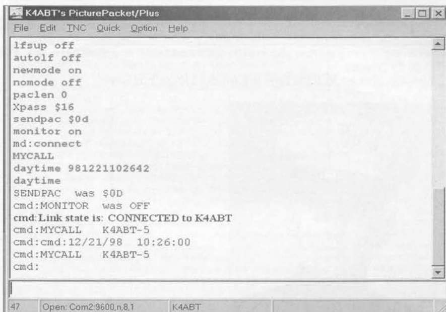
Figura 2. En esta imagen se muestra el «histórico» de las entradas y salidas, es permanente y con la posibilidad de desplazamiento hasta los primeros movimientos de entradas/salidas, no se permite la edición desde la pantalla. El contenido de los datos visualizados en pantalla es almacenado en disco y el programa los recarga cada vez que se arranca la aplicación. La cantidad de datos almacenados está determinado por la configuración realizada (filename.hst).
