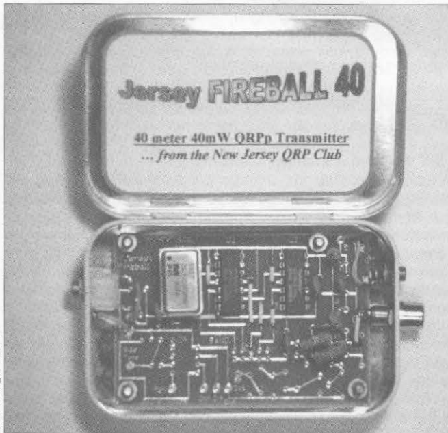
Figura 4. Se sabe que este equipo es QRP ¡porque se ha metido en una caja de sardinas! Este es un JF-40 completo y listo para funcionar. El manipulador opcional, el conmutador T/R y el amplificador de RF todavía han de ser instalados, pero aún así es una joya.
