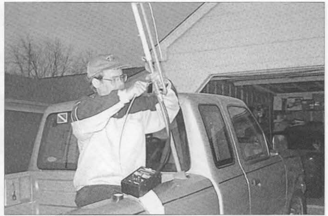
Foto 5. Eddie arrollando un hilo aislado para acoplar el «vivo» del conector SO-239 al elemento excitado, evitando un acoplamiento fuerte. [¿Has pensado qué has hecho, cómo queda la protección contra descargas estáticas? - K4ABT].
