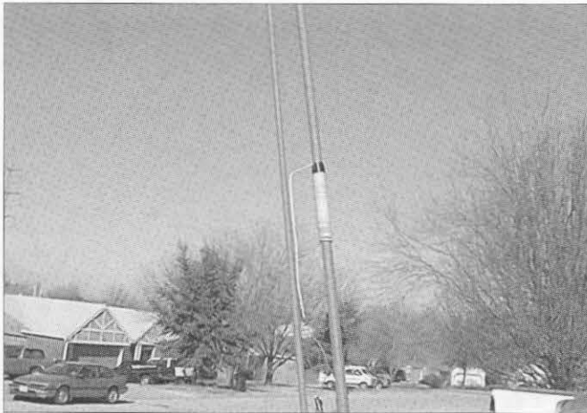
Foto 4. Hemos mezclado el concepto de la antigua antena J; se ha utilizado un cable aislado enrollado alrededor del elemento excitado.
