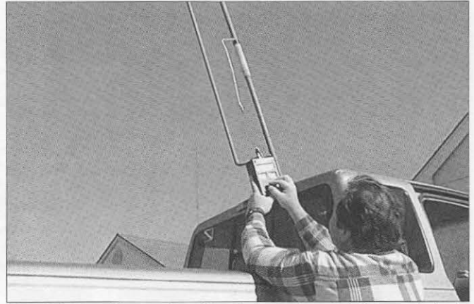
Foto 3. Es posible que la cabina de la camioneta influya en la lectura del medidor. Puede variar el punto de resonancia de la antena, debido a la modificación de la capacidad.
