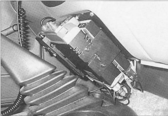
Foto 2. Detalle de la instalación móvil APRS, utilizando un TM-V7 de Kenwood y un KPC-3.
