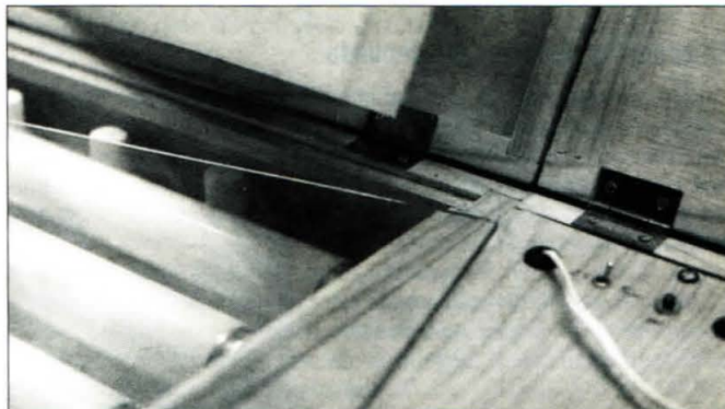
El cristal, separable, facilita la limpieza y el mantenimiento. La sección derecha de la caja aloja las reactancias de los tubos, el temporizador y los mandos correspondientes.
