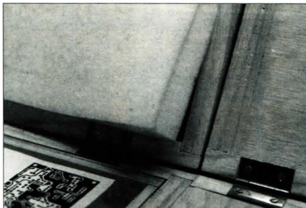
El fotolito positivo (pistas negras sobre fondo transparente) ha sido depositado sobre el cristal, listo para recibir encima la placa sensibilizada. Obsérvese el bloque de espuma elástica de la tapa, que mantendrá la placa y el fotolito apretados sobre el cristal.
