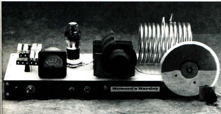
El oscilador Hartley se identifica por su válvula del año 1929 y por la bobina del circuito tanque realizada con tubo de cobre. Un disco compacto sirve como dial para la sintonía y contribuye a la reducción de la capacidad de la mano al aproximarla. En lo alto de la bobina, hacia la derecha, se halla la derivación de rejilla. El conductor más delgado de la izquierda constituye el eslabón de acoplamiento variable L1B.
