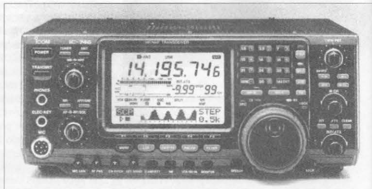
Foto B. La pantalla retroiluminada LCD del panel frontal del IC-746 proporciona cuanta información se precisa, desde la frecuencia y modalidad hasta un increíble conjunto de opciones personalizables utilizando las teclas de función por software del frontal.
