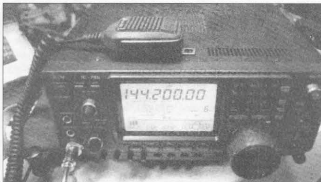
Foto A. Vista general del IC-746, que cubre todas las 9 bandas de HF más las de 6 y 2 metros, con una salida de 100 W en todas ellas. Además, la radio incluye un receptor de cobertura general desde 300 kHz hasta 60 MHz y de 108 a 174 MHz.
