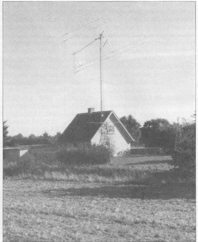
Antena para RL de OZ1HNE. 4x18 DJ9BV opt, polarización variable.
