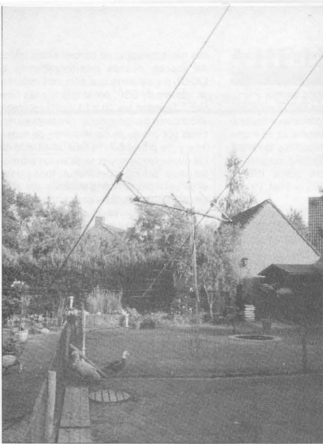
Formación 2x16 el. construcción casera de PAØJMV para RL con la que ha trabajado más de 550 estaciones.
