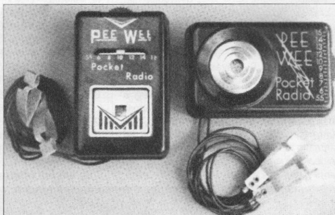
Foto 2. Dos versiones de los receptores de galena «Pee Wee» fabricados por Midway Co. y que se vendían por correo. ¿Algún lector recuerda estas bonitas cajitas de plástico anunciadas en la revista «Popular Electronics» de los años cincuenta. ¡A dónde habrán ido a parar hoy en día! (Foto cortesía del Dr. M.L. Sievers y de Sonoran Publishing Company).
