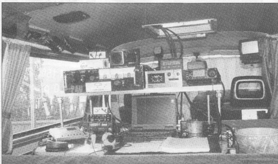
Cuarto de radio: Tx Kenwood TR-751, PA 4CX250B, Rx Dresler GaAsFET. PC Pentium y DTR MS/DF7KF.
