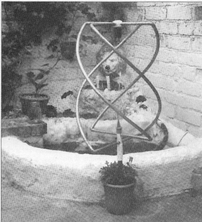
Figura 2. Antena QFH, construida por Paul Hayes según su manual «DIY». (Cortesía de Paul Hayes).
