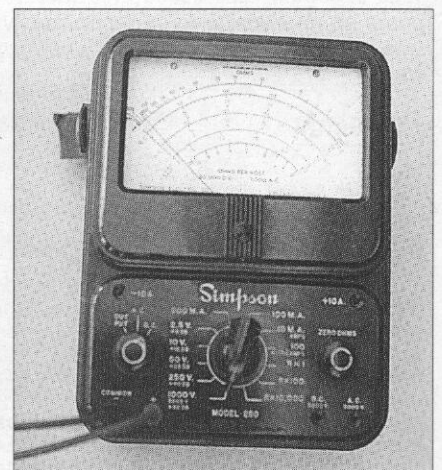
Foto B. Un ejemplo del tradicional multímetro de escala analógica es el famoso modelo Simpson 260. El conmutador central selecciona, conectándolos, distintos resistores multiplicadores y shunts precisos para leer diferentes alcances de tensión y corriente. Este instrumento, en particular lo «heredé» de mi padre, quien había diseñado el original 260 «a prueba de fuego» y éste fue el prototipo.
