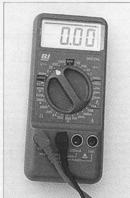
Foto C. Multímetro digital típico. Este tiene en su centro un conmutador giratorio que selecciona diversos resistores internos para proporcionar distintos alcances de medida. Lo fabrica Beckman Industrial Corp.
