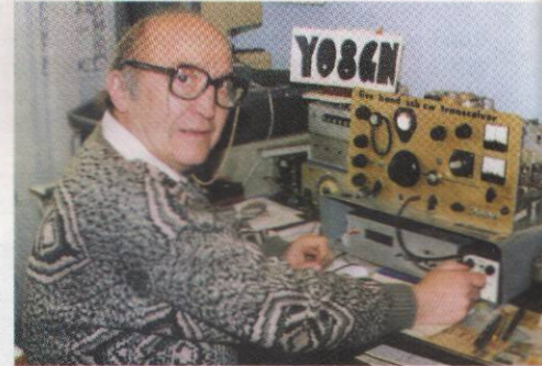
Los lectores que alguna vez hayan caído en la tentación de diseñar y montar un transceptor casero para CW y SSB, y además multibanda y a válvulas, sabrán apreciar la habilidad de Gelu, YO8GN.
