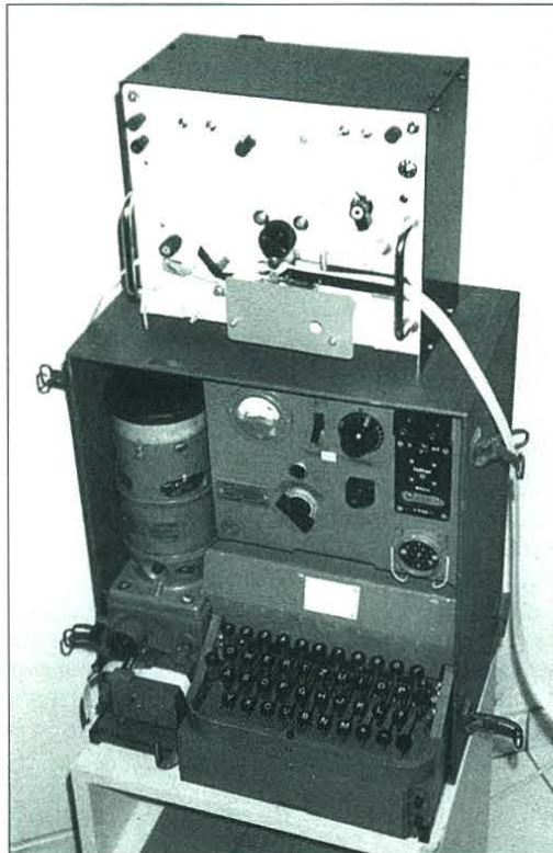
Sobre un auténtico FeldHell de la firma Siemens-Halske, de los utilizados por el ejército alemán durante la II Guerra Mundial, el receptor casero de Jan Smeets, ON4ASZ/EA3DPB, con el que se imprimieron algunas de las cintas mostradas en este artículo.
