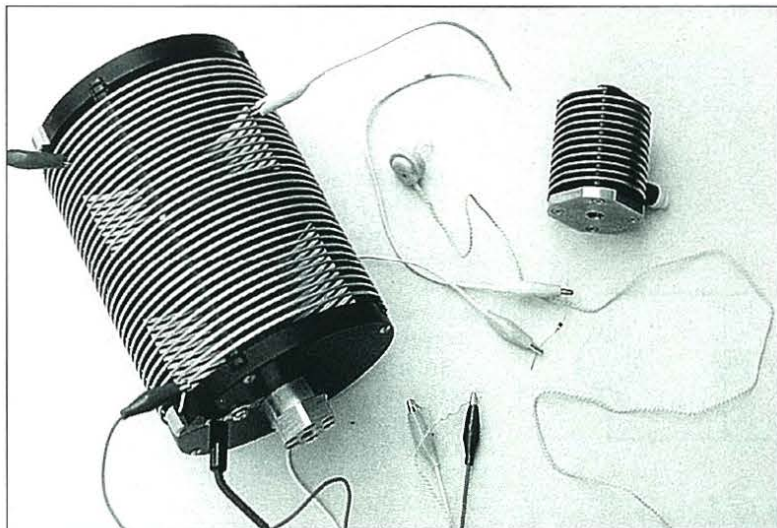
Foto 6. Mi kit «bonito e instantáneo» para la experimentación de circuitos y bobinas de receptores de galena. Está constituido por la bobina de carga de la antena para móvil «Fortex Stealth», una pequeña bobina de acoplamiento, un diodo 1N34, un auricular de alta impedancia y un puñado de puentes de cable con pinzas.
