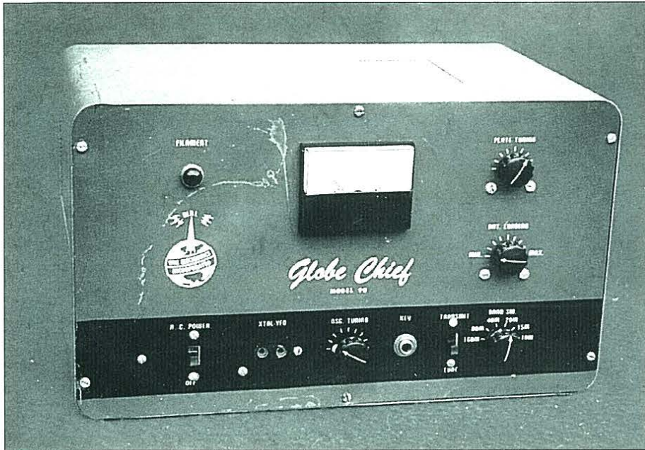
World Radio Laboratories (WRL) fue conocida por sus equipos grandes y pesados, que incluían las series de macizos Globe Champion y Globe King. En la foto se muestra un equipo relativamente pequeño y ligero: el transmisor de 90 W modelo 90 Globe Chief, de hacia 1956-1957. (Foto de Jim Hanlon, W8KGI, vía Electric Radio Magazine).
