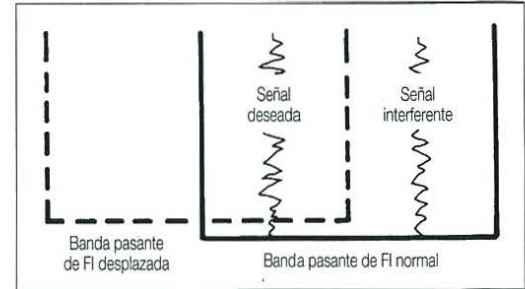
Figura 1. El desplazamiento de FI permite desplazar el centro de la banda pasante para intentar eliminar una interferencia de una señal próxima. Algunas radios permiten variar el ancho de banda para dejar fuera la interferencia.
