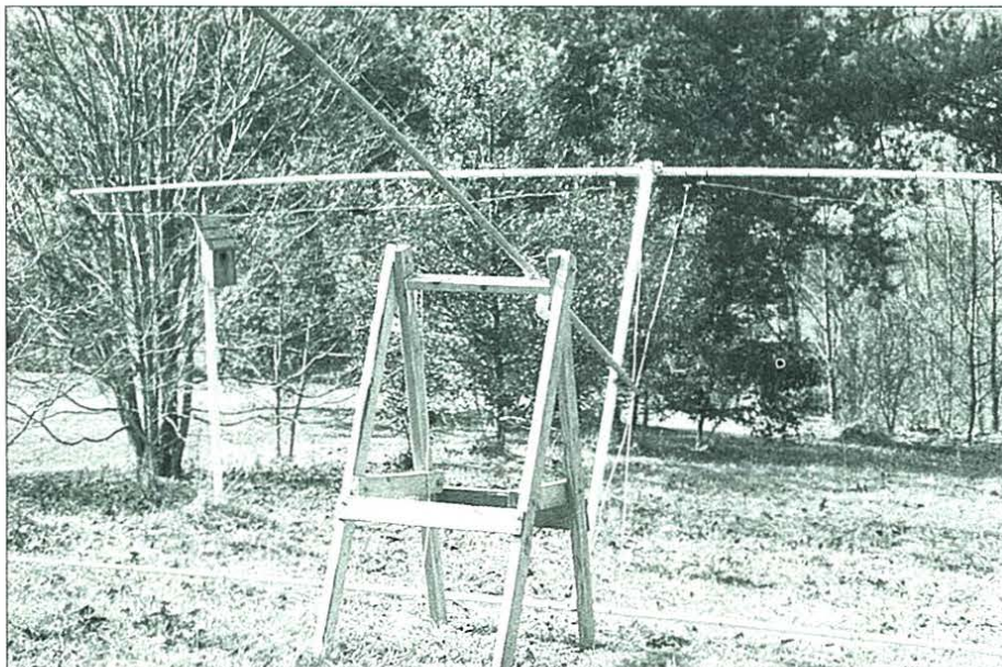
Foto C. La D2T montada en el mástil de prueba antes de elevarla para los ensayos.
