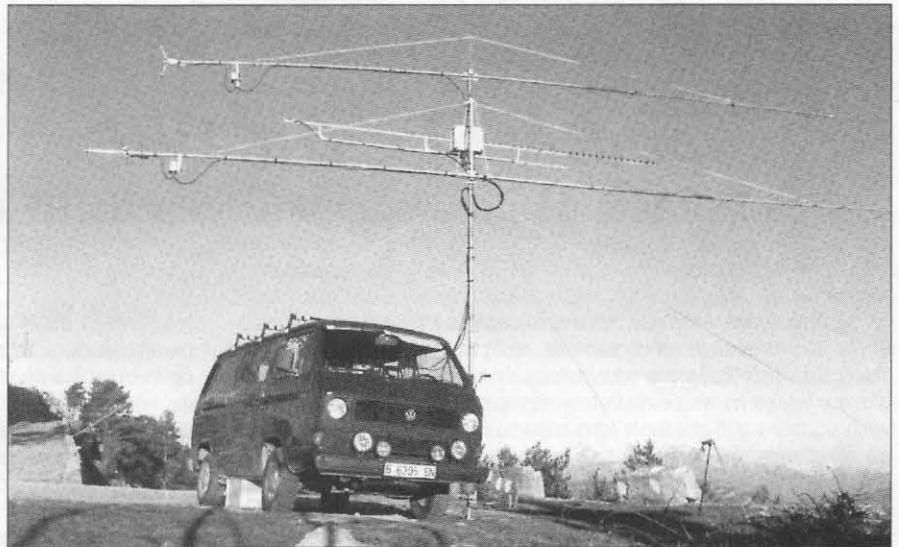
Una completa instalación portable para 144, 432 y 1296 MHz.
