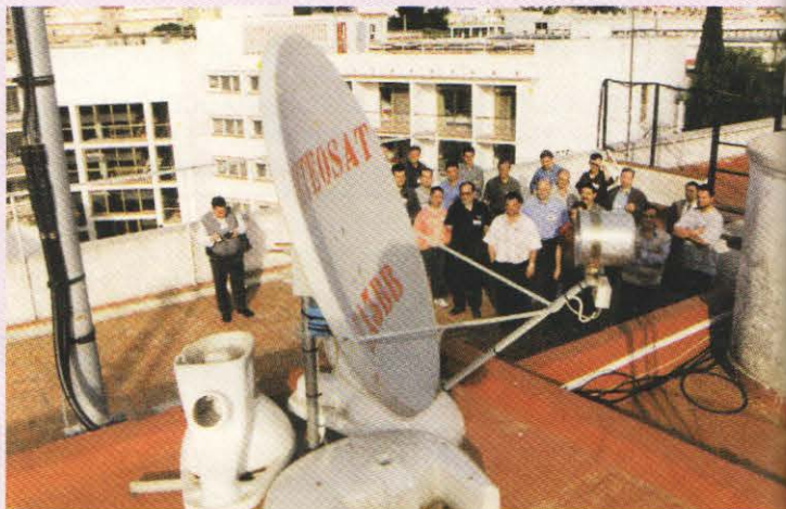
Sistema para recepción del Meteosat de EA3BB con iluminador de construcción doméstica y sistema de fijación ad-hoc «water-antimontana». Nótese la originalidad del material de contrapeso...).
