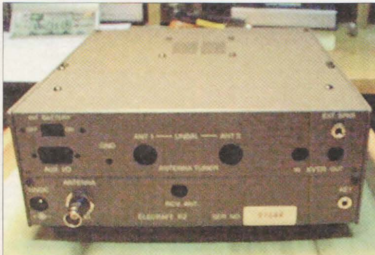
Parte posterior de la caja del K2, en la que pueden apreciarse las cavidades previstas para acoger los aditamentos opcionales.
