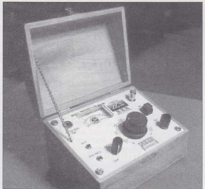
Foto E. Vista interior del mueble elaborado y personalizado por Jim, N5IB, que contiene el transceptor de construcción propia GM30. El acceso a todos los controles y conectores se efectúa por encima y la tapa puede guardar la hojas de «log».
