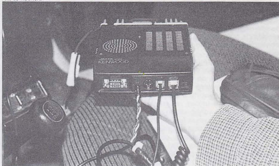
El cuerpo del TM-D700 puede ser montado bajo un asiento, o bajo la bandeja. Se conecta mediante un cable al frontal de control, montado remotamente.
