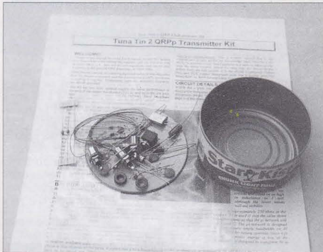
Foto C. ¡Vista atrás! Ésta es la versión actual del legendario transmisor Tuna Tin 2 de W1FB de «hace 25 años». El circuito tiene actualizados los toroides e inductancias, lleva un cristal de 7.040 kHz y saca una sana señal de salida de 400 mW. El chasis para el montaje es una lata de atún (no incluida).
