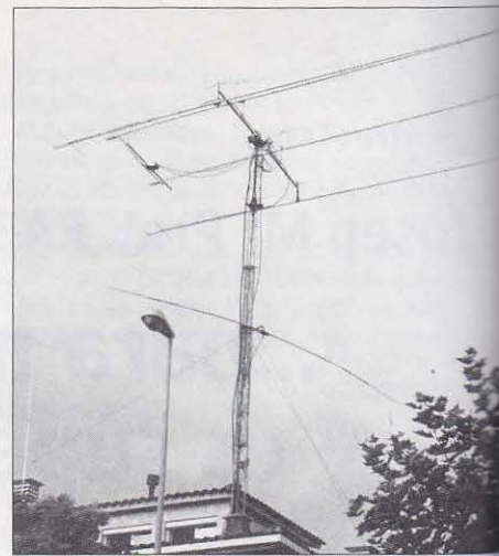
Antenas (2 x 17 VHF + 2 x 38 UHF) con las que Josep M.ª logra sus espectaculares resultados.
