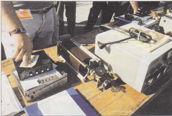
Una pieza rara: un inductor a rodillo para «trabajo pesado» que cambió de manos antes del mediodía del sábado.
