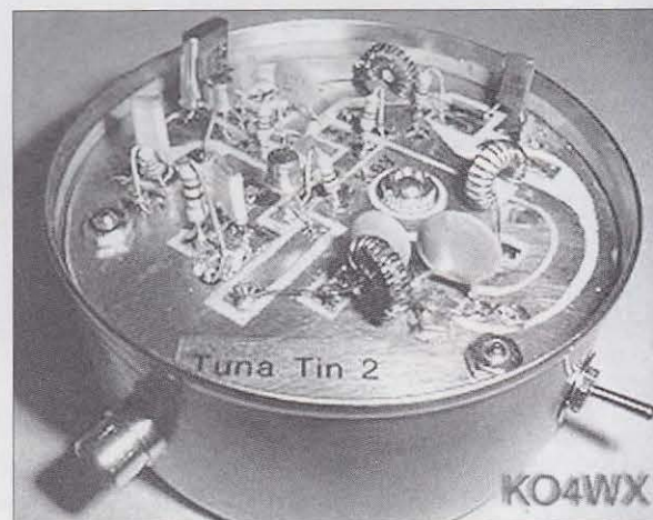
Foto 2. El Tuna Tin personalizado por KO4WX, las pistas del circuito están trazadas por la cara superior de la placa.
