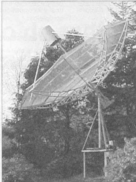
Randy Stegemeyer, W7HR, construyó esta parabólica de 5 m para su utilización como radiotelescopio. Para más detalles ver su Web <http://www.signalone.com/radioastronomy/telescope/>
