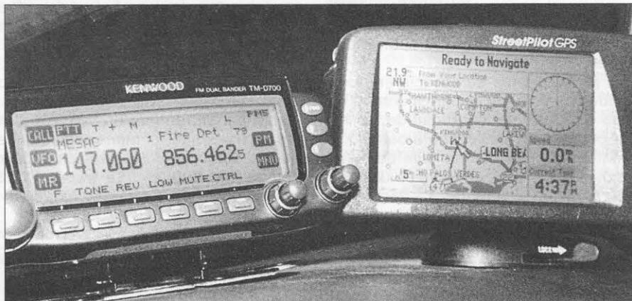
En la fotografía, un transceptor de VHF, emparejado con un receptor GPS (Sistema de Posicionamiento Global) y enlazado con un repetidor APRS permite visualizar estaciones APRS en un mapa.
