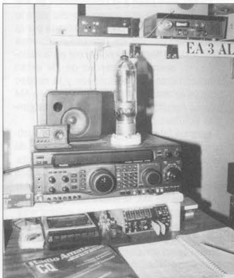
En 1950, para obtener 100 W de RF se precisaba una gran válvula como la mostrada y un «acompañamiento» considerable. Hoy, un equipo de sobremesa entrega igual potencia en un volumen y peso muy inferior.
