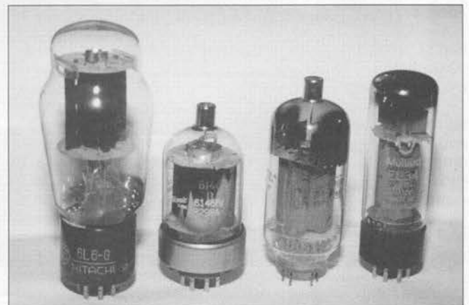
De izquierda a derecha: tres tetrodos de haces; una 6L6G, una 6146B (derivada directa de la anterior), una 6JF6A, diseñada originalmente para deflexión horizontal de TV y un pentodo europeo EL34.
