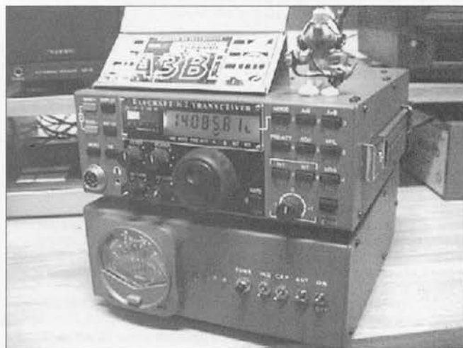
Figura 8. Línea del receptor K2 y el acoplador. Obsérvese el asa y el botón de sintonía.
