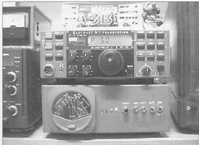
Figura 10. El K2 en transmisión con una potencia de 5 W, que es confirmada por el instrumento Daiwa, que al tiempo muestra una ROE de 1:1.
