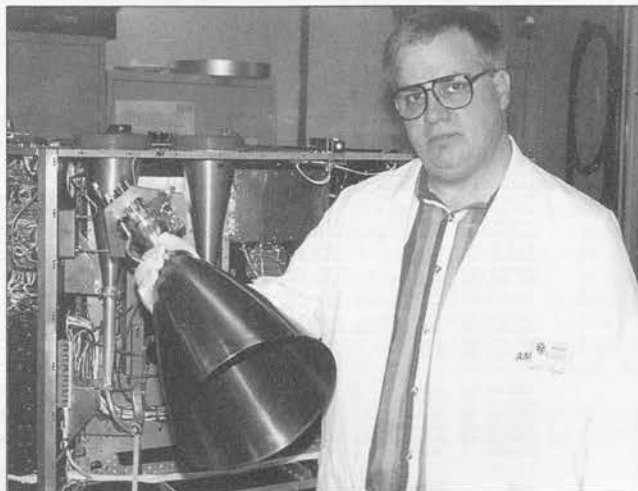
El voluntario de AMSAT, Rick Leon, KA1RHL sostiene en su mano la tobera del motor del AO-40. Es relativamente pequeña, pero capaz de proporcionar un poderoso empuje de más de 6,5 g.
