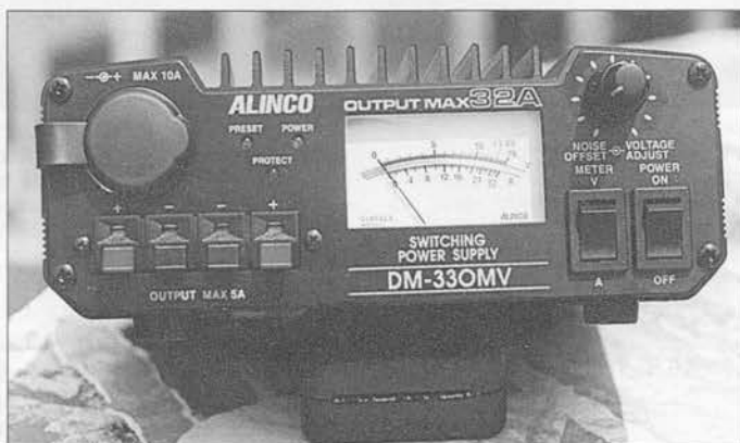
Vista frontal de la DM-330MV, mostrando los distintos mandos y el instrumento de medida dual. El conmutador de la medida en tensión o corriente está a la derecha del instrumento.
