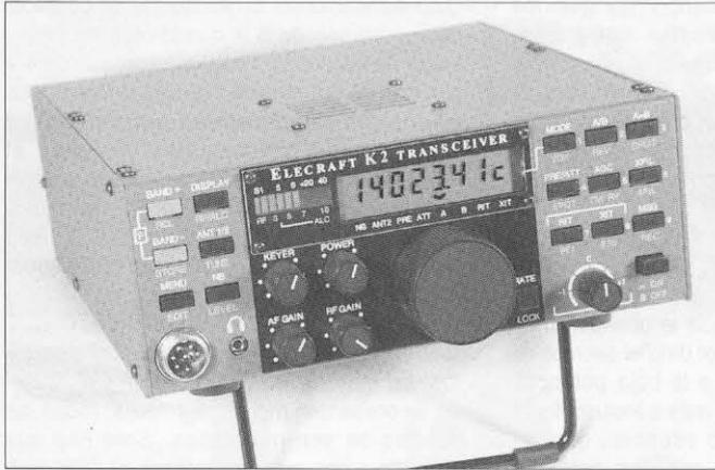
Foto 3. Si le interesa el montaje y uso de un transceptor en kit de alto nivel, el nuevo Elecraft K2 con su placa de BLU opcional instalada, es la elección más inteligente. La pequeña joya incorpora numerosas funciones de los «grandes equipos» y tiene un gran futuro en el mundo del QRP.
