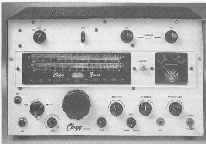
Foto 3. Transmisor de AM y CW *Clegg Zeus*, de 175 W para 6 y 2 metros, controlado a OFV. Fue introducido en el mercado en 1961.
