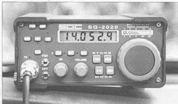
Foto 1. El SGC-2020 es un transceptor QRP multibanda para BLU de reducido tamaño. Es pequeño, robusto, eficiente y está cargado de características de operación de lujo.
