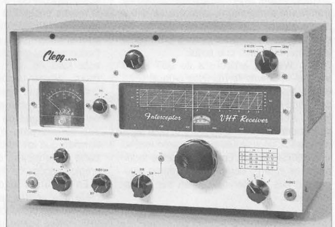
Foto 4. Un receptor para acompañar al *Clegg Zeus*, el *Interceptor*, que recibía SSB, además de AM y CW.
