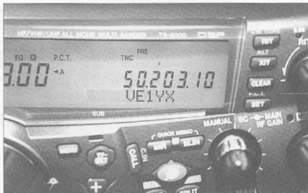
La TNC incorporada puede ser utilizada para recibir el tráfico del nodo local de cluster, e informar automáticamente de alertas DX -como en la foto, donde vemos un anuncio de VE1YX en 50,203.10 MHz- e incluso conmutar el VFO principal y la antena a la frecuencia anunciada. (Foto de WB6NOA).
