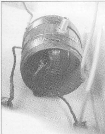
Foto 5. La posición de una bobina respecto a la otra determina la potencia de salida.
