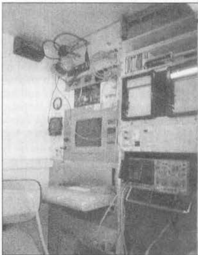
El interior del radiotelescopio del SARA, con ordenadores, fuentes de alimentación y el equipo para la observación de Júpiter y meteoritos.
