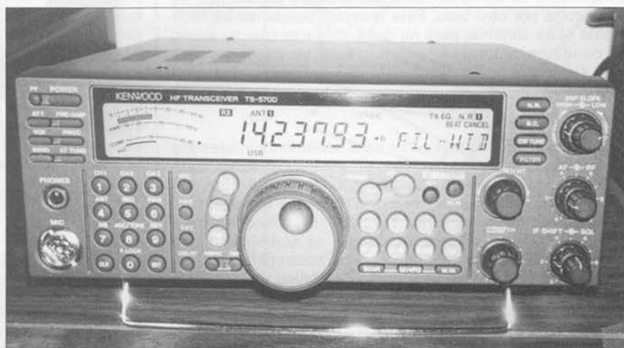
Foto A. Las posibilidades del DSP están incorporadas o son opcionales en un número creciente de transceptores modernos. Se las usa para reducción del ruido de banda (NR), eliminar notas de batido (BC) y QRM difuso variando la pendiente de los filtros pasabanda. Algunos sistemas DSP operan en la FI, mientras otros lo hacen en audio. ¡Todos funcionan muy bien!
