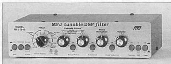
Foto B. Las unidades externas DSP, tales como la MFJ-784B, son ideales para mejorar las prestaciones de los modelos económicos de transceptores. Reducen el ruido, eliminan los batidos heterodinos y reducen la banda pasante del receptor. La interconexión con un transceptor ya existente es un sencillo conector. (Foto de MFJ Enterprises).
