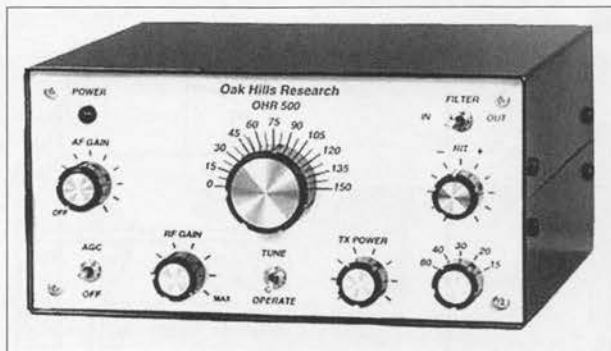
Foto 5. El transceptor para cinco bandas OHR500. Este equipo es bastante popular entre los aficionados al QRP y da una buena impresión en el aire.
