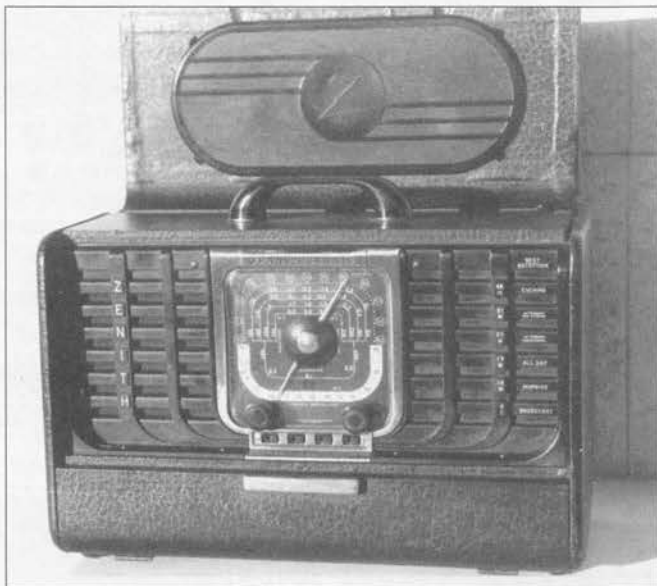
De este modelo de la serie 8G005, que utiliza válvulas «Loctal», se fabricaron unas 110.000 unidades entre 1946 y 1949.
