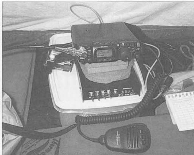
Un sintonizador de antenas hace más sencillas las operaciones portables multibanda.
