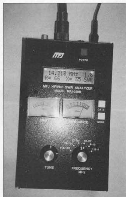
Foto A. El analizador de antena MFJ-259B es una unidad compacta fácil de usar y que es ideal para comprobar ROE, anchos de banda y cables coaxiales; preseleccionar controles manuales del sintonizador; y mucho más. Aquí en el cuarto de radio «en el extremo del coaxial» está comprobando la ROE de una antena vertical de cinco bandas, tal como se expone en el texto. Antes de ajustar la longitud superior de la antena, la ROE es de 1,8:1 a 14,218 MHz.
