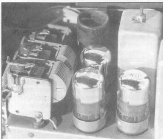
Vista interior del 8G005 con válvulas Loctal.
