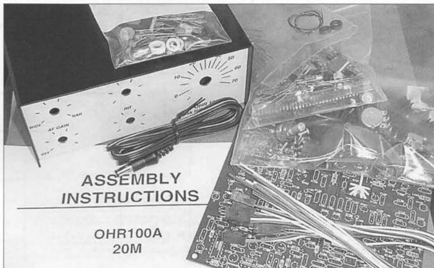
Foto 2. Así es como se ve el kit del OHR100A al abrirlo y antes de empezar su montaje. La placa de circuito impreso está serigrafada con la situación de los componentes fácilmente visible y tiene orificios metalizados para asegurar conexiones sólidas.
