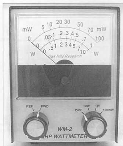
Foto 6. El vatímetro WM2 de la Oak Hills puede leer potencias a partir de 5 mW con buena precisión.
