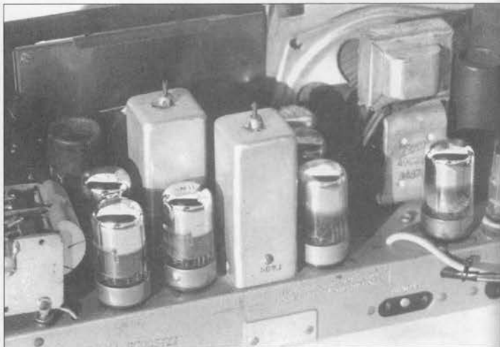
Vista del chasis de la serie 8G005, que está equipado con siete válvulas «Loctal» más una válvula rectificadora.
