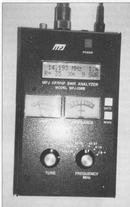
Foto D. De nuevo en mi cuarto de radio, vuelvo a comprobar la ROE «en la punta del coaxial». Ahora muestra 1,4:1 a 14,193 MHz. (Perdón, pero no lo puse exactamente a 14,218 MHz justamente antes de hacer la foto. Perdón de nuevo por el reflejo del flash de la cámara fotográfica). La resintonía fue un completo éxito.
