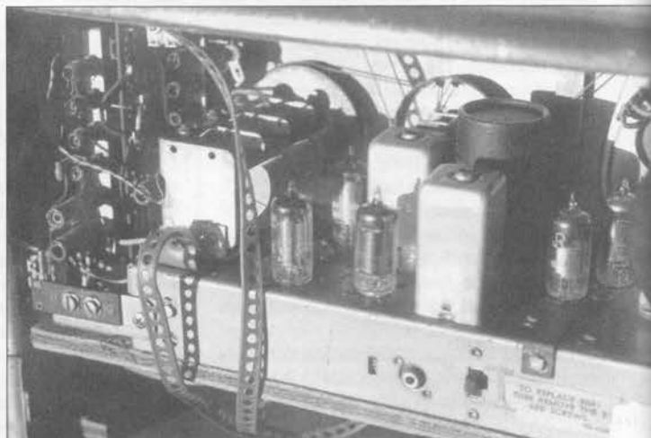
La cinta perforada visible junto a la sección de RF del chasis de la serie 600 es la conexión de las antenas
