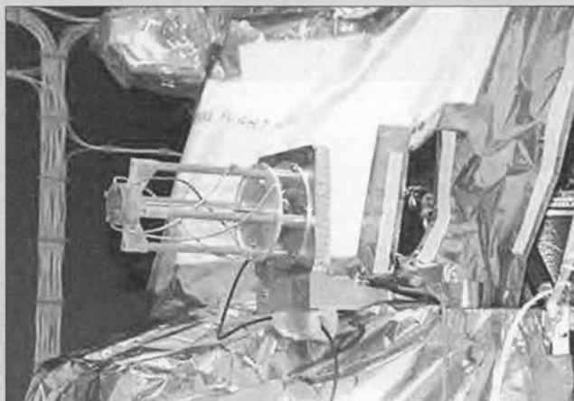
Vista de cerca de la antena de hélice cuadrifilar de UHF de la Mars Odyssey. (Foto NASA).
