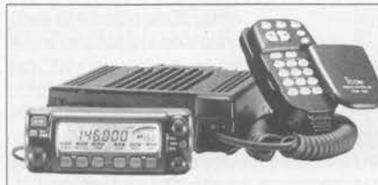
El IC-207H de Icom es un tranceptor bibanda (una banda a la vez), que tiene una gran pantalla con gruesos caracteres y una sencilla secuencia de programación para grabar canales rápidamente.
