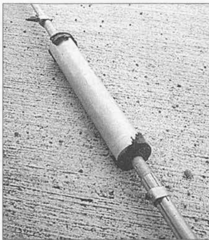
Figura 5. Trampa de una Wilson System 3 antes de ser reconstruida, mostrando los tapones picoteados por los loros.
