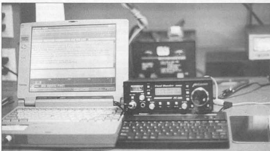
Aquí está el PC-500 con un teclado de ordenador conectado y a su lado un ordenador portátil que está unido a él a través de la entrada de micrófono para operar en modo PSK31. Se utiliza un cable opcional para la conexión entre el ordenador y la radio. Para que el PC-500 pueda trabajar en el modo PSK31 se precisa también una placa VOX opcional.
