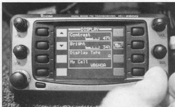
El IC-2800 de Icom es un «banda dual» con un cabezal delgado, dotado de una pantalla en color y que puede reproducir imágenes de TV o vídeo, mapas APRS procedentes del ordenador o cualquier otra cosa en formato NTSC.
