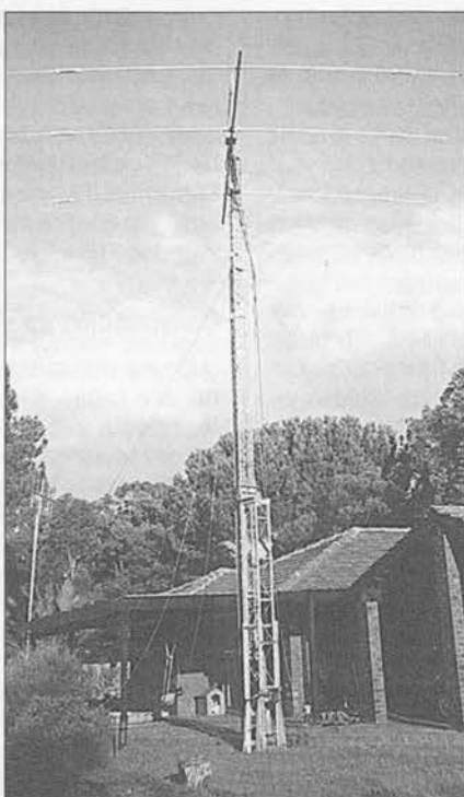
La Yagi tribanda con trampas reconstruida por el autor, en el aire y trabajando en 20, 15 y 10 metros.
