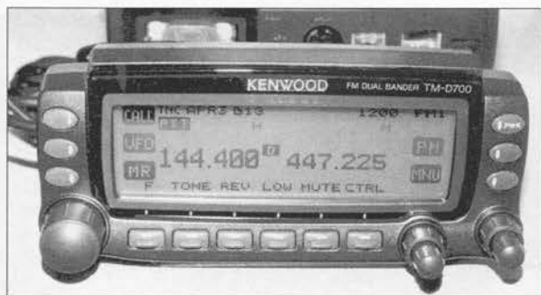
El D-700 de Kenwood lleva dentro un TNC y la capacidad APRS. Añadiendo un receptor GPS se puede operar en las bandas mientras se viaja por las autopistas.
