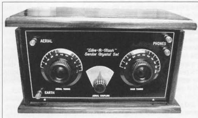
Foto E. Absolutamente magnífico es el calificativo que merece esta versión –de estilo Gran Gatsby – de la radio a cristal Levinson, construida por David Walshaw. Obsérvese el cuidado acabado y la detallada rotulación de mandos y terminales. (Foto cortesía de David Walshaw y The Crystal Set Society ).
