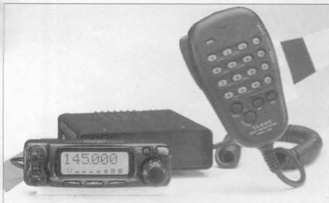
El transceptor bibanda FT-90R de Yaesu (una banda activa a la vez). Con solamente una banda a la vista, se ve más fácilmente cuando lo manejamos en la autopista.
