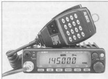
El DR-135 de Alinco está preparado para poder añadir una tarjeta TNC en su interior.
