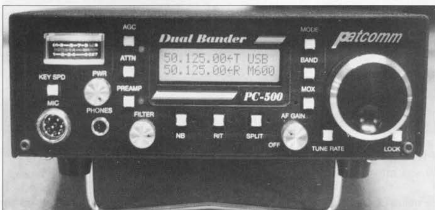
Vista del panel frontal del transceptor bibanda PC-500. Tiene un gran medidor de S (a la izquierda del panel) y una pantalla LCD de dos líneas donde se muestra la frecuencia, una de las líneas para el modo de recepción y la otra para transmisión.
