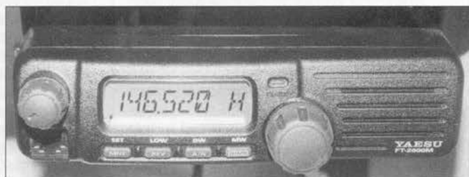
El FT-2600 M de Yaesu, hecho para trabajo duro, tiene un altavoz frontal. Aunque es un monobanda, está construido según la línea de servicio móvil terrestre de la firma y funciona bien.
