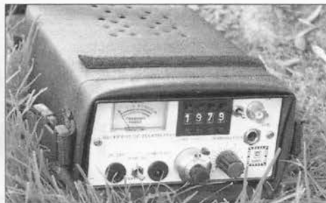
Foto C. El receptor tipo 116, en sus diversas variantes, puede cubrir 400 canales de 10 kHz en cada uno de los márgenes de 4 MHz en seis bandas de V-UHF a elegir.
