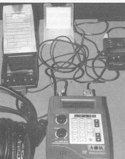
La terminal multimodo AOR (abajo) puede copiar PSK31 y RTTY sin necesidad de ordenador y produce una simulación de CW en estéreo. Es también un filtro externo DSP y ecualizador de micrófono. Enlazada a un PDA (Personal Digital Assistant) cargado con un programa de terminal (como el dispositivo Palm de arriba a la izquierda) puede enviar y recibir RTTY y PSK31.
