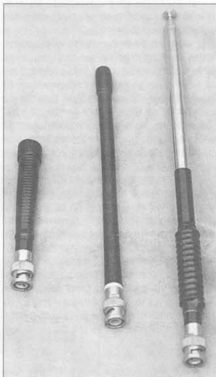
Las antenas para portátiles vienen de todos tamaños y formas, y pocas de ellas son eficientes. La de la izquierda es una típica antena corta de «porreta», que pierde en rendimiento lo que gana en conveniencia de tamaño. La del centro es una antena «estándar» de goma y la de la derecha es una antena teles-cópica de media onda. (Fotos por W2VU).
