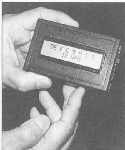
Uno de los numerosos y nuevos accesorios presentados este año por MFJ: este lector de código capta señales de un altavoz y presenta en su pantalla LCD el mensaje de código recibido.
