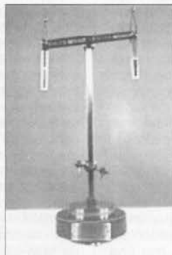
Figura 8. Telegrafía óptica: un modelo del telégrafo de Chappe.
