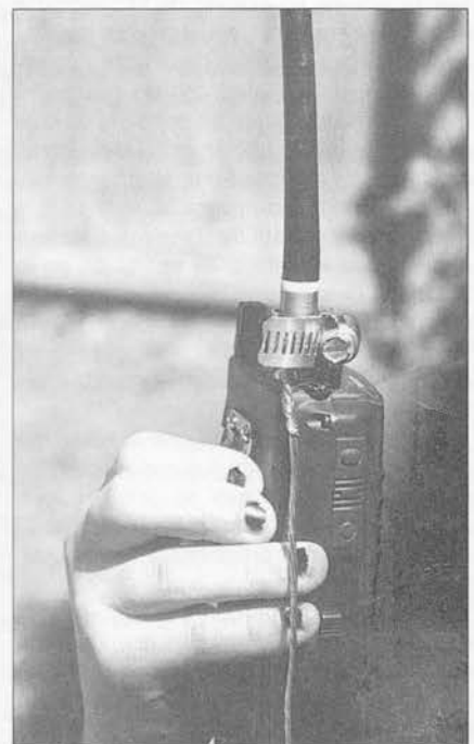
Detalle de la abrazadera de conexión del radial de «tierra» fijada a la base del conector de antena del portátil.
