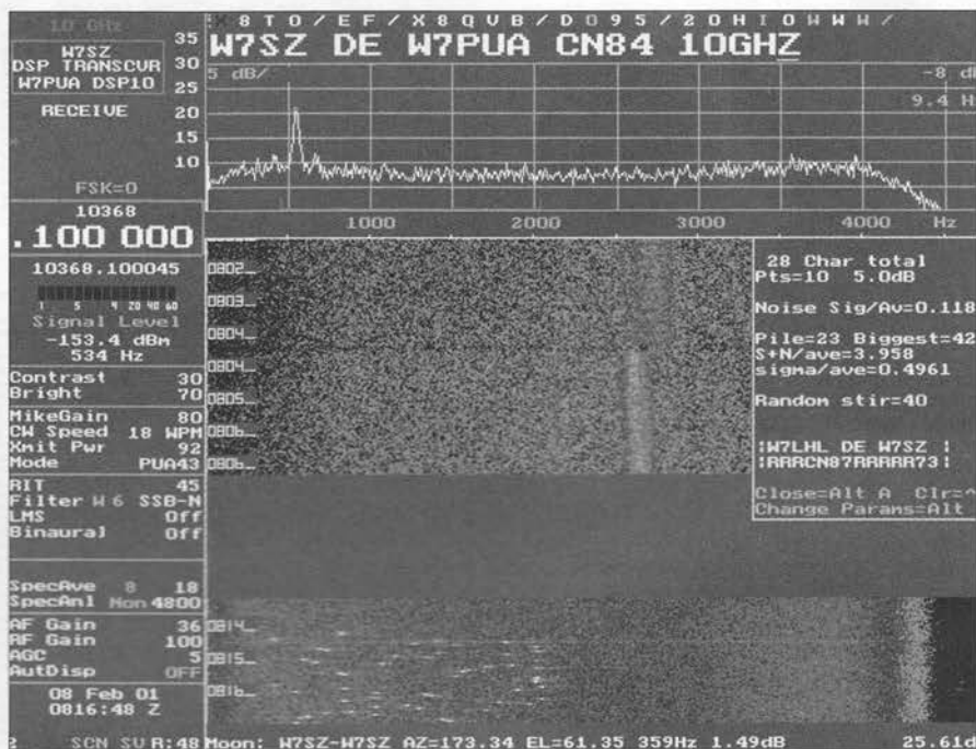
Software de control del transceptor DSP-10 para 144 MHz, en este caso trabajando en 10 GHz a través de un transversor.
