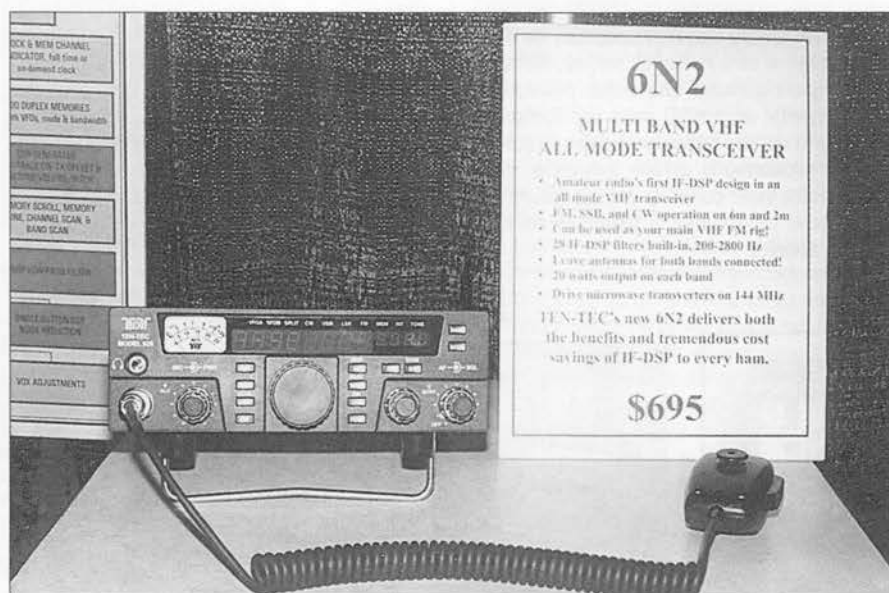
El transceptor multimodo de VHF 6N2 de Ten-Tec es una de las nuevas radios presentadas en Dayton 2001, que parecía más bien un año propicio para accesorios solamente. El 6N2 trabaja en 2 y 6 metros y es el primer y único equipo de VHF que incorpora proceso digital de señal.
