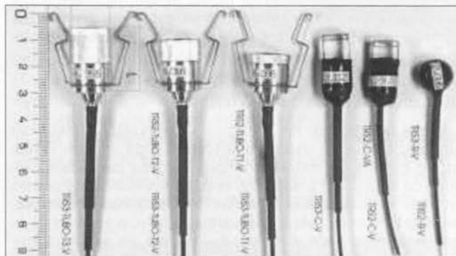
Foto B. Algunos de los transmisores usados en cetrería. El emisor de la izquierda pesa 15 g y tiene un alcance de más de 50 km, con una autonomía de 6 días, mientras que el ejemplar de la derecha pesa solamente 2,8 g y puede ser escuchado a 8 km durante 4 días.
