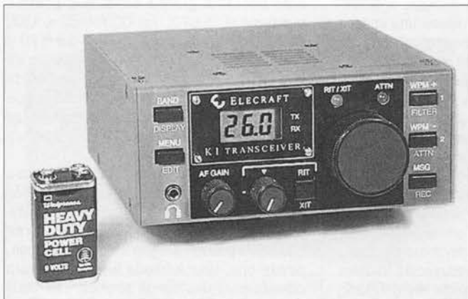
El nuevo kit K1 de Elecraft es un transceptor bibanda de HF que saca 5 W y mide solamente 5 x 12,5 x 14 cm.
