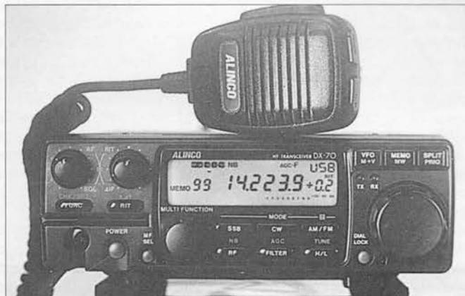
El DX-70TH de Alinco viene ahora con alta potencia (100 W) y con la banda de 6 metros añadida a las de HF.
