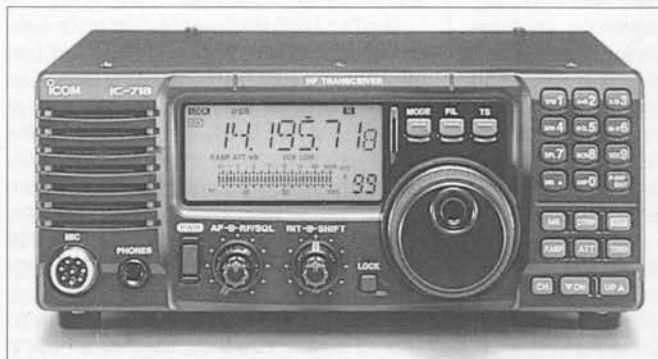
El IC-718 de Icom no es necesariamente una caja pequeña ni tiene los 6 metros, pero entrega 100 W de salida en HF, tiene 101 canales de memoria y una pantalla LCD muy grande.
