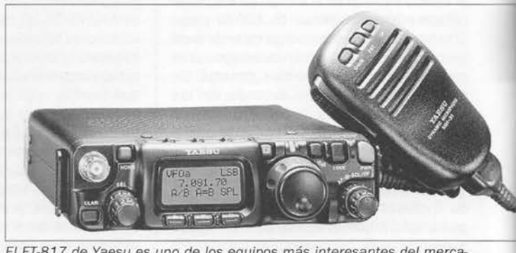
El FT-817 de Yaesu es uno de los equipos más interesantes del mercado actual, diseñado como una radio QRP para ser llevada en bandolera y funcionar en cualquier sitio. Tiene 5 W de salida en HF, 2 metros y 70 cm y opera en CW, SSB, FM y AFSK para modos digitales.
