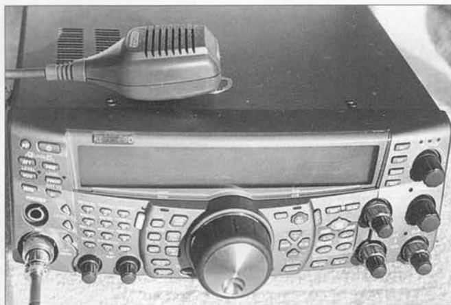
El nuevo TS-2000 de Kenwood ofrece HF, 6 metros, 2 metros y 432 MHz, todos el multimodo, con una unidad opcional interna para 1.200 MHz. Es lo adecuado para el trabajo en satélite.
