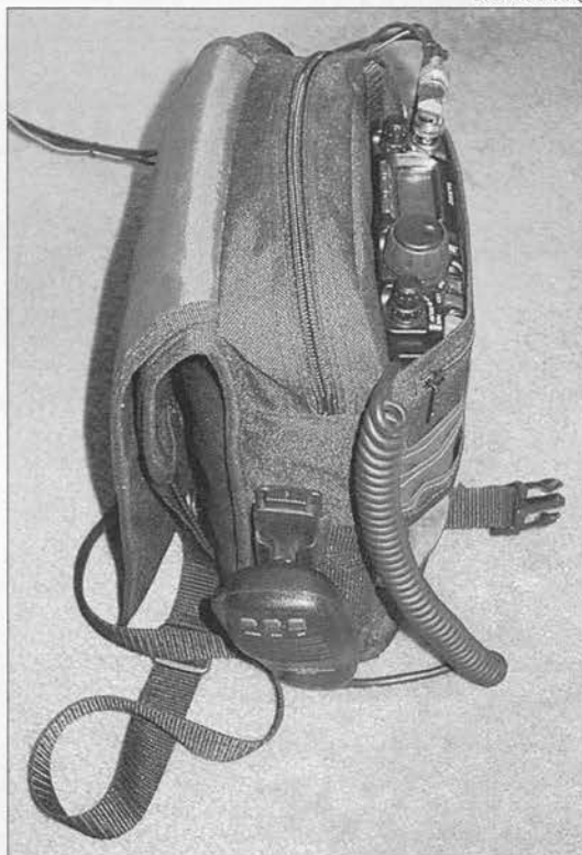
Todo embalado y listo para su uso. El FT-817 del autor está adecuadamente empacado en un saco de costado para acceder fácilmente al mismo durante la marcha o el paseo.
