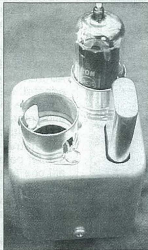
Prototipo completo del Cali-Kit o kit calibrador de cristal de cuarzo.
