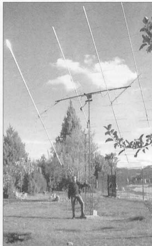
Nueva formación 4 x 12 elementos tipo DL6WU/VE7BQH para rebote lunar.
