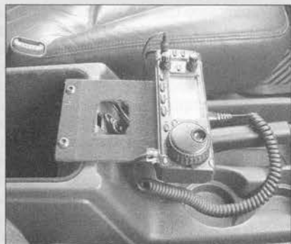
Conjunto de control, montado en la consola central del vehículo. Véase el texto para los detalles de fijación y protección de las partes de la consola.
