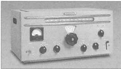
El 20A de Hunter Cyclomaster apareció en 1948. El corazón del equipo es un PTO.
