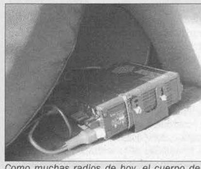
Como muchas radios de hoy, el cuerpo del IC-706 puede ser instalado en un lugar apartado, como un rincón poco usado en el departamento de carga del todoterreno del autor.
