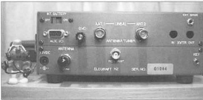
Figura 9. Parte posterior del K2 en el que prácticamente se han llenado todos los huecos. Obsérvense los conectores 1 y 2 para antenas no balanceadas. En la parte central inferior el conector destinado únicamente a una antena de recepción. A su izquierda el conector de antena básico que queda inutilizado al tener instalado el acoplador.
