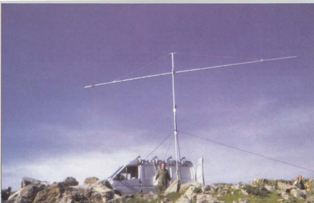
EA2URE en IN92pw. Antena Yagi de 17 elementos sobre 6 m de mástil.
