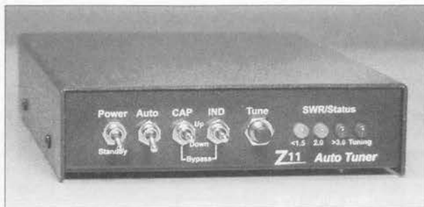
Acoplador automático Z-11 de LDG Electronics. La razón por la que el Z-11 se ha popularizado junto al FT-817 es que una vez efectuado el trabajo de sintonía (unos segundos) el acoplador pasa a estado de reposo con un consumo de unos microamperios. Además, es casi del mismo tamaño que el FT-817.
