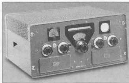
El transmisor 100V de Central Electronics generaba SSB por el método de fase. Su oscilador maestro es también un PTO.
