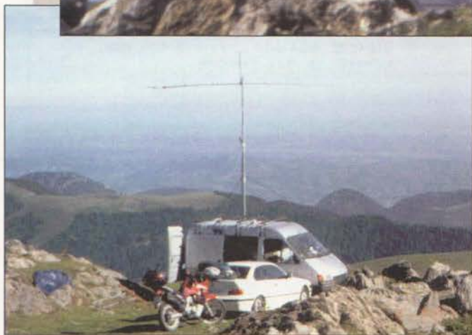
EA2URE en IN92pw. Antena Yagi de 17 elementos sobre 6 m de mástil.
