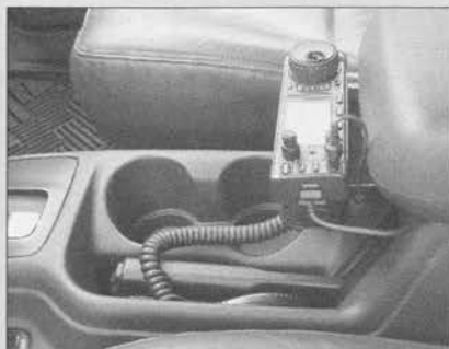
El panel de control de la radio del autor, unido a una placa de acero, de construcción casera, antes de su instalación.
