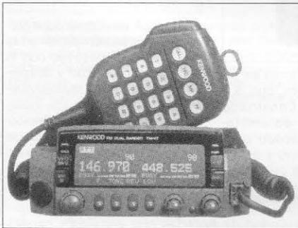
El TM-V7A de Kenwood es un típico doble banda o banda dual FM usado en instalaciones base/móvil. Entre sus características está un cabezal separable, lo que permite montar el cuerpo de la radio bajo un asiento y el cabezal en el salpicadero del vehículo.
