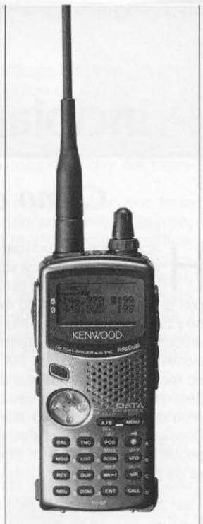
El TH-D7A de Kenwood agrega una dimensión digital a los portátiles. Se construyó con la capacidad de recibir y desplegar mensajes de radiopaquete cortos y el software incorporado para enviar y recibir mensajes de APRS (Sistema de Automático de Información de Posición).
