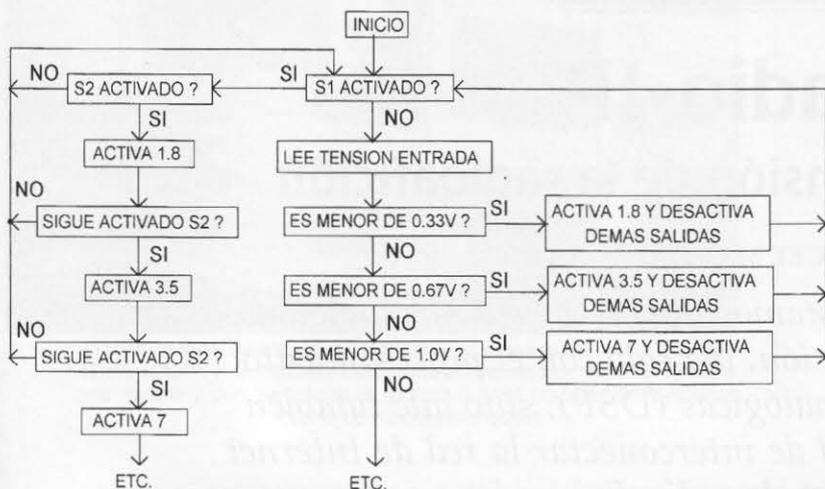
Figura 4. Diagrama de flujo simplificado del programa para el PIC16F876.
