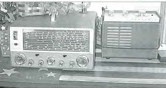
He aquí un GC-1 «Mohican», que he sintonizado en 40 metros AM. Es estupendo para escuchar las estaciones de AM durante los fines de semana. Al lado hay un GR-88 que permite escuchar a la policía local.
