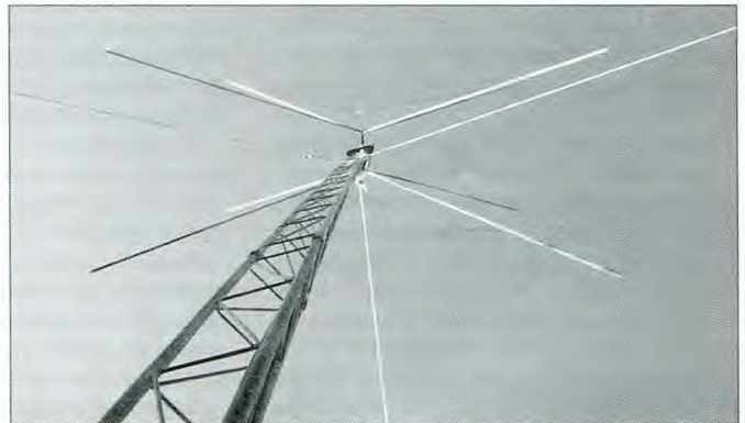
La antena cúbica auxiliar para 15 metros supuso una buena ayuda al permitir explorar el horizonte con independencia de la antena principal para esa misma banda.
