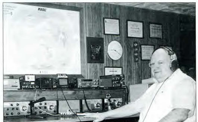
Foto I. Aquí está Don Lemley, W8DL, al timón de su estación QRP. El equipo QRP de 5 W (con el que Don ha trabajado 75 países en sus ratos libres) es el Ten-Tec 556 Scout, que está a la izquierda del estante superior al lado del IC-746.
