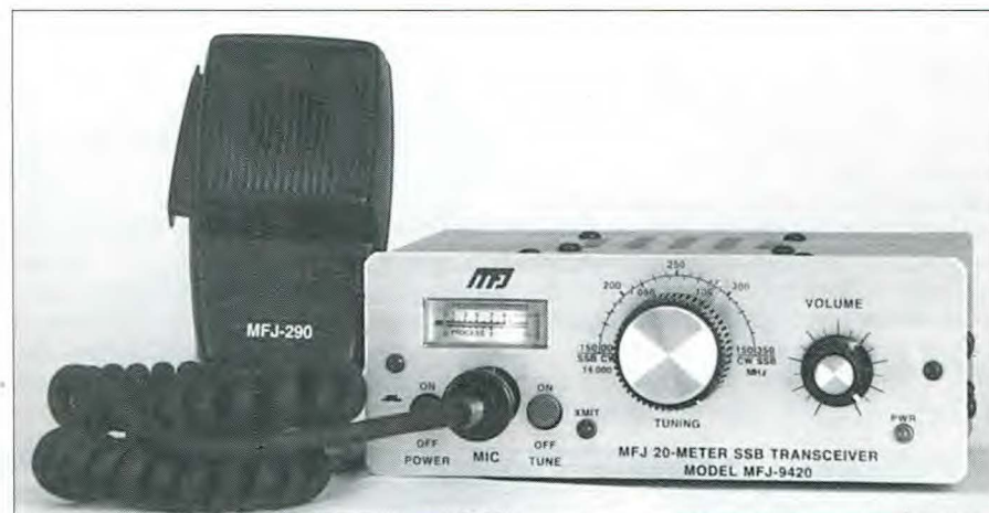
Foto D. La serie de transceptores para SSB «94» son ampliamente utilizados para QRP en móviles. Estas unidades disponen de un eficiente compresor de voz, filtro de 3,3 kHz de 8 polos, altavoz en la parte superior y un sólido acabado. (Foto cortesía KC5NSZ y MFJ).
