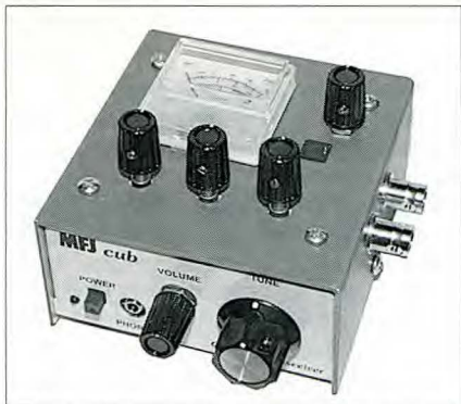
Foto B. La nueva opción Tune Top para el popular transceptor Cub está ya a punto en el banco de I+D de MFJ. Contiene un pequeño acoplador de antena que sintoniza cualquier cosa, desde dipolos a hilos largos, además de un medidor de ROE/potencia que facilita la operación de campo. Nota: el acoplador de la tapa es el prototipo de Martin Jue, K5FLU; la unidad final de producción comercial (que estará disponible muy pronto) será ligeramente diferente. (Foto cortesía de KC5NSZ y MFJ).
