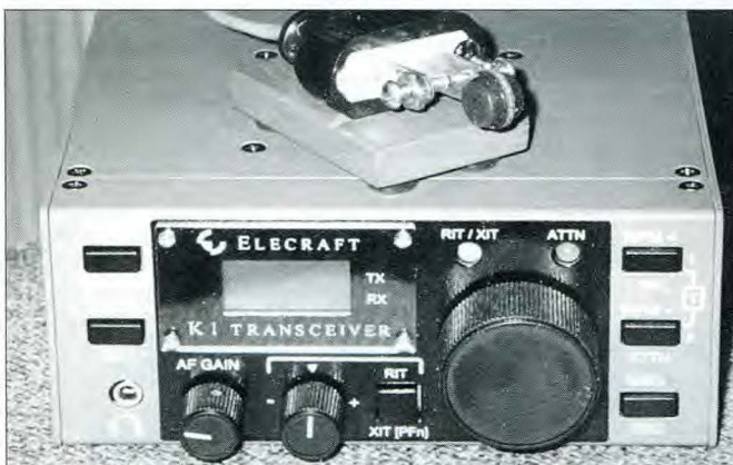
Foto H. El manipulador de clavija de red eléctrica, encima del receptor K1 de Roger, de forma que se pueden comparar los tamaños. Roger dice que el manipulador trabaja muy bien y está pensando en adaptarlo para su familia de equipos.
