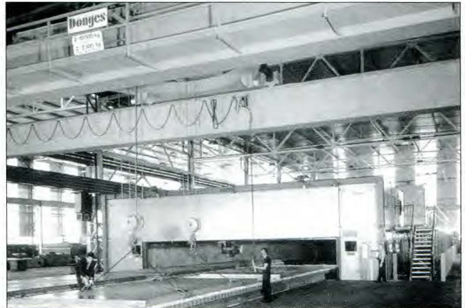
Una línea de corte de plancha.
