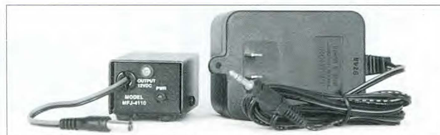
Foto E. Esta es una pequeña y atractiva fuente de alimentación para QRP: la MFJ-4110. Genera 13,8 V a 1,2 A y se lleva en el bolsillo de la chaqueta. (Foto cortesía de MFJ Enterprises).
