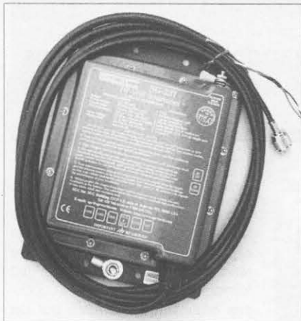
Foto E. Los acopladores automáticos de antena, tales como este compacto SGC modelo 237, instalados en el punto de alimentación de una antena, adaptan la impedancia y reducen la ROE a pie de antena. Este concepto tiene la ventaja de minimizar la radiación y captación de señales por la malla del cable y es el preferido a menudo en operaciones poco aparatosas.
