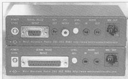
Vista trasera de la RIGblaster (debajo) y la RIGblaster Plus (encima), que muestra los conectores adicionales incorporados al modelo Plus . Véase el texto para detalles.
