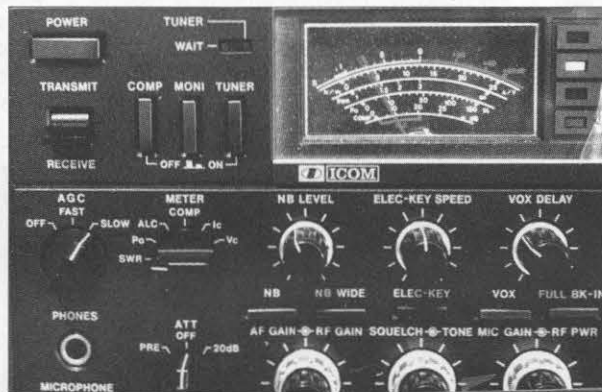
Foto B. Los sintonizadores automáticos que incorporan los equipos Icom son analógicos, con motores que ajustan condensadores variables. Y funcionan muy bien.
