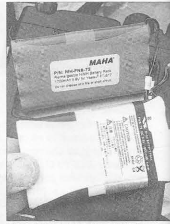
El paquete de baterías sellado de NiMH MH-FNB-72 de Maha, que reemplaza al de NiCd para el FT-817 de Yaesu, proporciona cerca del doble de tiempo de operación por carga.
