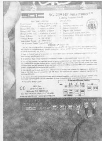
El pequeño acoplador SG-239 de SGC, que puede adaptar prácticamente cualquier de antena de hilo para el uso en portable del FT-817, el propio SG-2020 de SGC y otros equipos QRP.
