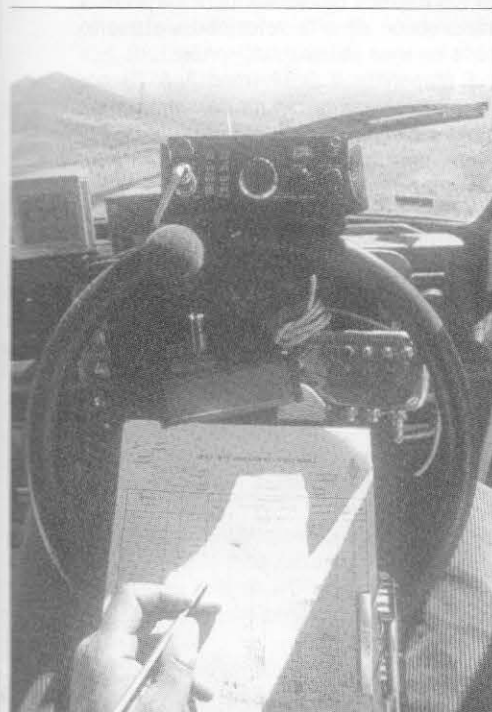
Situación de los equipos en el «puesto de operación» de la EA2COI. Observar la ridícula sencillez, la lata es el grabador digital temporizado de voz para las llamadas.
