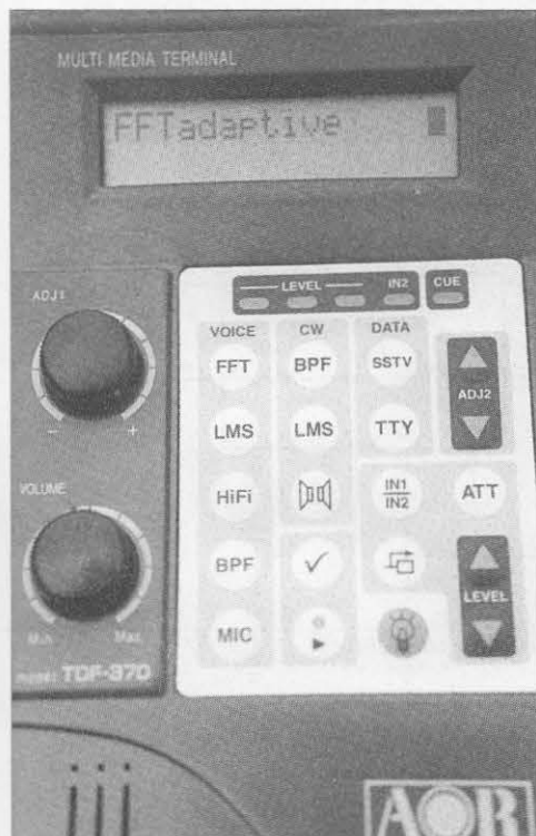
Los botones táctiles del panel frontal permiten configurar el TDF-370 al tipo de señales que se tengan que tratar.
