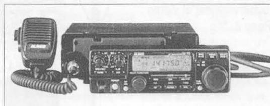
El DX-70TH de Alinco con cabezal remoto es un equipo móvil de 100 W con la banda de 6 metros incluida y un receptor caracterizado por una selectividad extrema.
