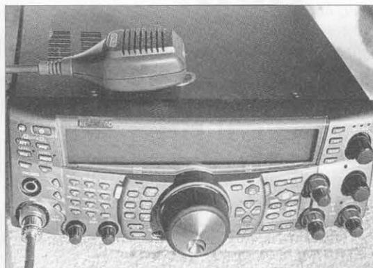
El transceptor multimodo para base o móvil para HF/VHF/UHF TS-2000 de Kenwood puede ser pedido con el módulo opcional para 1.240-1.300 MHz instalado de fábrica y designado entonces como TS-2000X.
