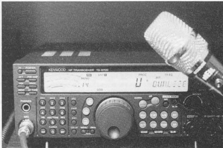
Foto A. Como este TS-570 de Kenwood, la mayoría de los modernos receptores incluyen alguna forma de ecualización seleccionable por menú que permite adaptar la respuesta de audio al micrófono y la voz del operador.
