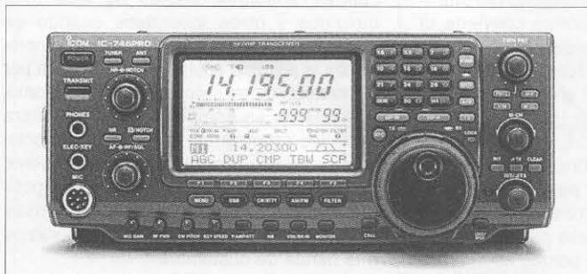
Icom ha mejorado el IC-746 con el IC-746PRO añadiéndole un DSP de 32 bit, supresor de parásitos de nivel variable, sintonía sincrónica SSB/CW, filtros digitales seleccionables en FI, filtro de ranura automático e incluso un demodulador y decodificador de RTTY.
