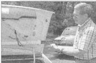
Joe Collins, N0FNF, comprobando las antenas y los látigos contenidos en el tubo de PVC, que está fijado con un poco de cuerda a la tapa del maletero del auto. (Fotos del autor).
