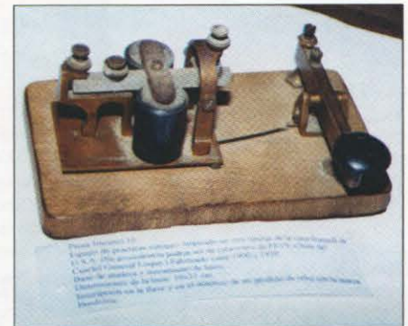
Foto 28. Los ferrocarriles usaban estaciones como ésta, fabricada alrededor de 1920 y copiada de una original Bunnell (USA).
