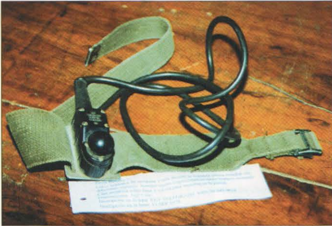
Foto 25. Creado a mediados de la década de los cuarenta, este manipulador británico «de pierna» siguió en uso hasta recientemente.
