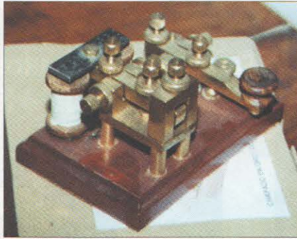
Foto 22. Las estaciones telegráficas ferroviarias hacían amplio uso del receptor acústico, como el mostrado en este prototipo.
