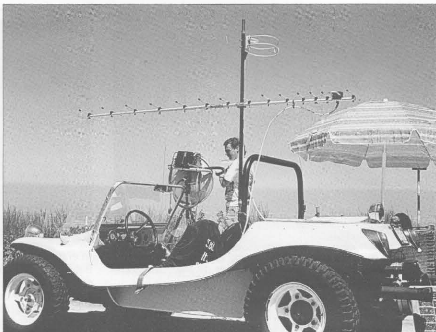
Sí, puede poner una antena direccional de 2 metros en su coche, pero es muy poco práctica para utilizarla durante la conducción. Esa es la razón por la que la mayoría de aficionados que operan en 2 metros SSB en móvil, donde la antena horizontal es una obligación, usan diferentes tipos de antena de halo. (Fotos de WB6NOA).
