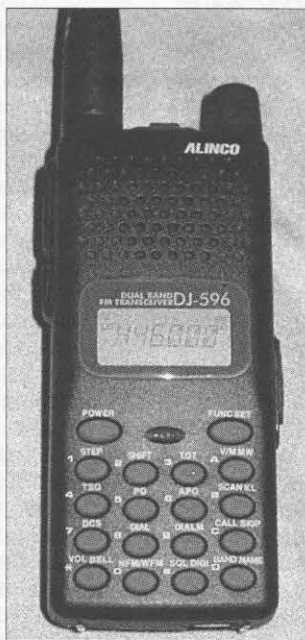
El DJ-596T es, en parte, un portátil analógico FM banda y, por otra parte, añadiendo una tarjeta opcional, un transceptor pionero en voz digital.
