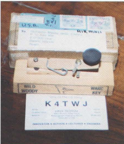
Foto 20. Dave Ingram, K4TWJ, gustaba de gastar bromas como la de este manipulador Wild Woody, hecho con una pinza de tender ropa.
