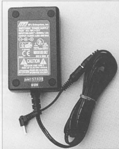
Foto 1. La nueva fuente de pequeño tamaño MFJ-1317 es una piedra preciosa. La unidad tan sólo mide 3,5 cm de alto por 6 cm de ancho y 10 cm de profundidad y suministra 13,8 V a 2,89 A, suficiente «zumo» como para alimentar todos sus equipos de QRP a la vez. La fuente se suministra con los cables y conectores apropiados para enchufarlo al FT-817.
