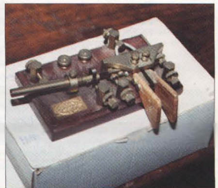
Foto 18. Este original manipulador lateral semiautomático tiene el dispositivo oscilante de los «puntos» en posición lateral.
