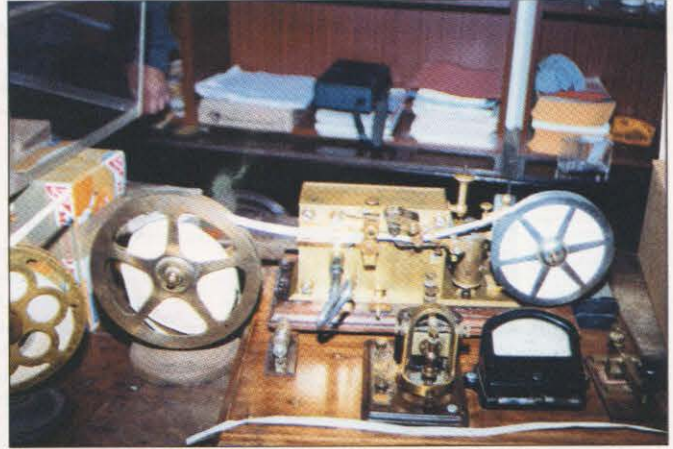
Foto 26. Ésta es una estación telegráfica completa usada hasta hace poco en la red de ferrocarriles. En primer plano, el relé «amplificador».
