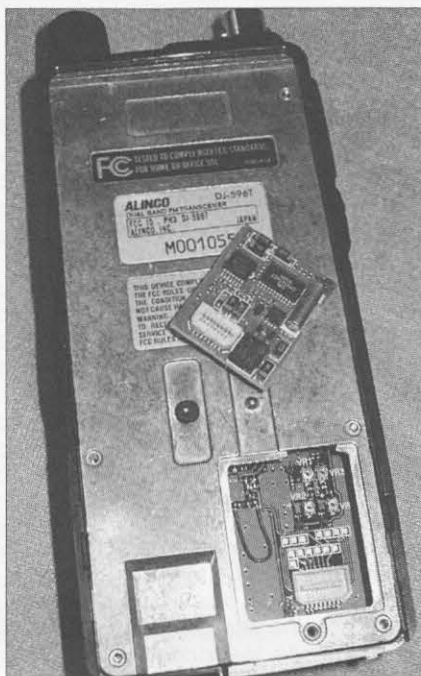
La tarjeta de audio digital EJ-43U (vista justo antes de la instalación) se inserta en un zócalo especial cerrado por una compuerta de trampa en la parte trasera del DJ-596T. (Foto de W2VU).
