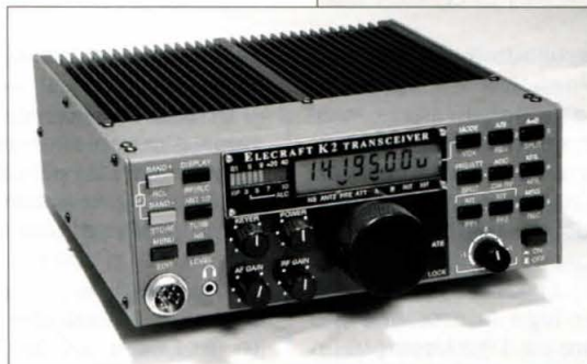
La instalación QRP del autor: un transceptor Elecraft K2 con 12 W de salida, y un antena Bencher Skyhawk tribanda, que ofrece ganancia tanto en transmisión como en recepción.
