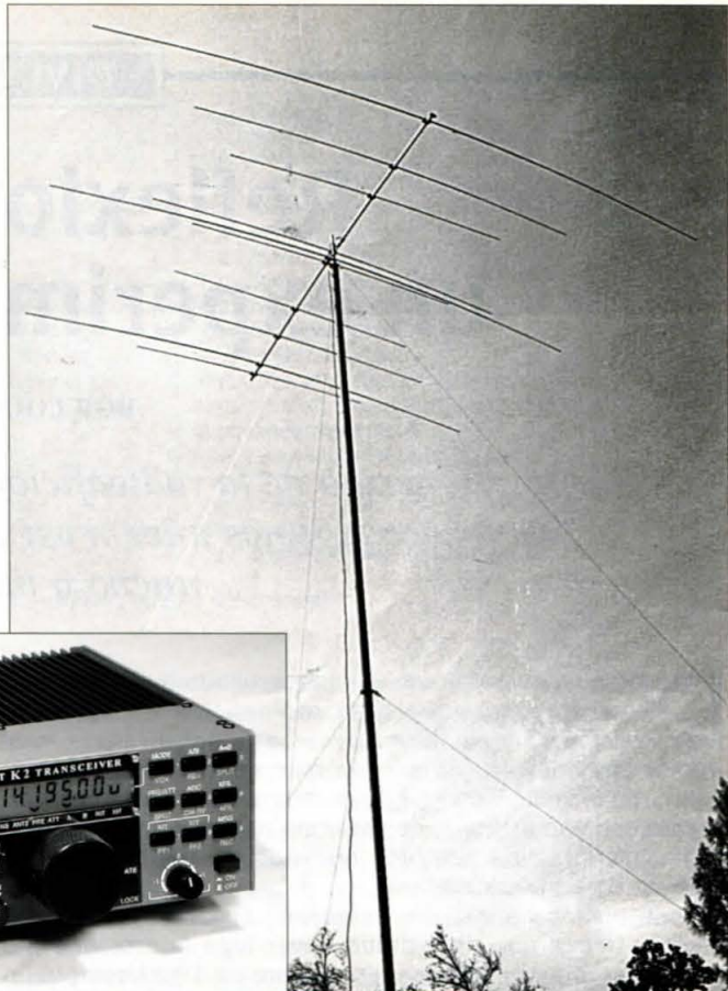
La instalación QRP del autor: un transceptor Elecraft K2 con 12 W de salida, y un antena Bencher Skyhawk tribanda, que ofrece ganancia tanto en transmisión como en recepción.
