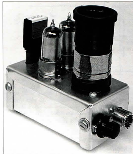
Foto A. Increíblemente bonito y atractivo son los adjetivos aplicables a este transmisor de estilo 1950 con válvulas 1S4. Puede ser configurado para las bandas de 80, 40 o 30 metros y alimentado con pilas o con una pequeña fuente de CA. Es un gran equipo QRP «ocasional».
