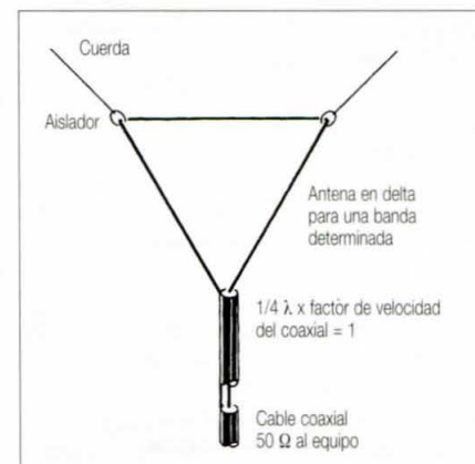
Figura 4. Una línea de transmisión de 1/4 \lambda utilizada para transformar la impedancia del punto de alimentación de una antena en lazo delta de 100 a 50 \Omega , para una adaptación directa a un cable coaxial de 50 \Omega .
