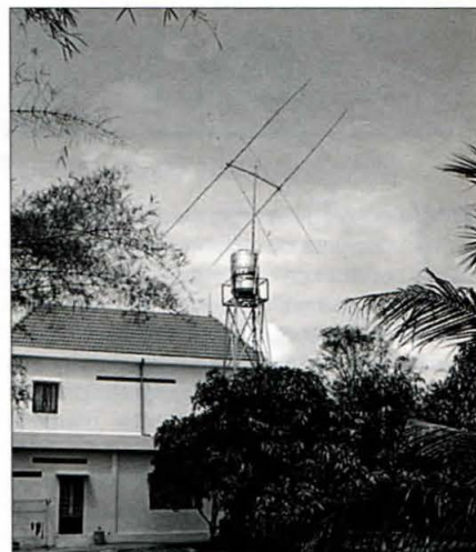
Ésta es la antena cúbica -de construcción casera- de Karl, W9XX/3W2XK, que nos dice que los espaciadores de bambú son muy fáciles de encontrar allí y que sobreviven bastante bien. Karl vive unos meses al año cerca de Saigón y su indicativo norteamericano, curiosamente, había pertenecido en los años 30 a una de las estaciones patrón de EEUU.
