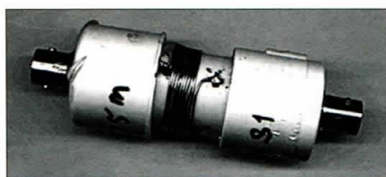
Foto A. Esta bobina para 15 metros es un ejemplo de las bobinas de banda construidas por el autor para su antena multibanda portátil para HF.
