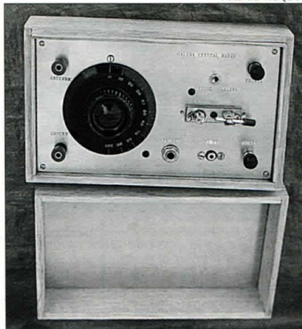
Foto B. Una fina creación casera es esta radio a galena hecha por Leonard Gardner, W2QBC, que muestra un genuino dial National «Velvet Vernier», un detector de «bigote de gato» y los terminales etiquetados en caracteres dorados sobre una placa de cobre lacado fijada a una caja de madera de roble blanco.
