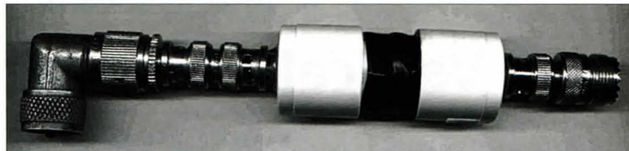
Foto E. La bobina para la banda seleccionada se instala entre una serie de adaptadores y conectores que unen la antena con el transceptor. Usando tubo de PVC de 25 mm es posible utilizar conectores SO-239 y eliminar algunos adaptadores BNC-PL.
