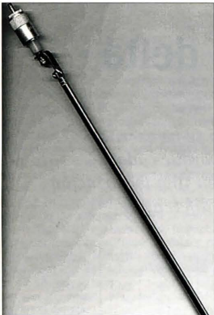
Foto C. Un látigo de 2,40 m, hecho con una antena telescópica, se instala en lo alto de la bobina. Se puede ajustar la longitud del látigo para obtener el acoplamiento perfecto en cada banda.
