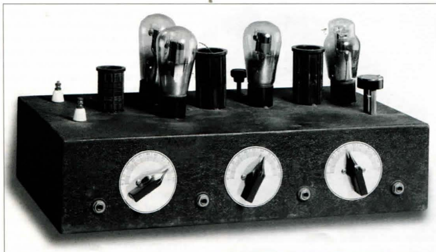
El transmisor CW-25 de Gross equipaba un par de válvulas tipo 46 en push-pull en la salida y entregaba 25 W desde 160 a 20 metros.
