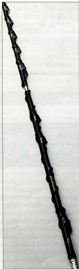
Foto D. Aunque invisible bajo la capa de resina que la cubre, la popular antena Outbacker utiliza una bobina helicoidal que sirve tanto como elemento como de bobina de carga multibanda. El cable arrollado es básicamente un puente para seleccionar las bandas.
