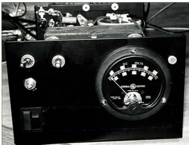
Foto A. Vista frontal de la fuente de alimentación automática y cargador. Por supuesto, debe ser cubierta cuando está en uso.
