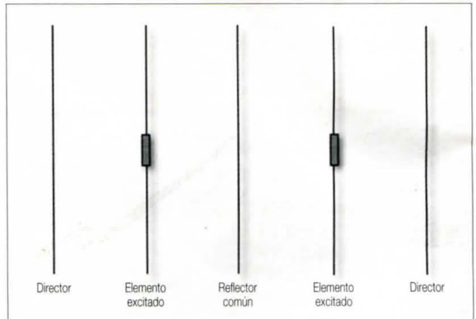
Figura 1. El conjunto de 5 elementos parásitos son en realidad dos Yagi de 3 elementos que comparten un reflector común.
