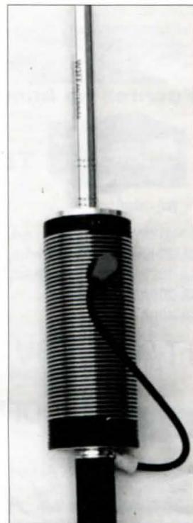
Foto B. Este nuevo dipolo portable Buddipole utiliza elementos más largos y menos espiras de hilo en la bobina, dando por resultado una mayor eficiencia y mejores prestaciones. (Véase texto.)
