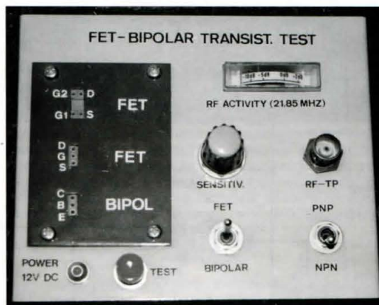
Foto 1. Vista exterior del comprobador de transistores. Se puede apreciar la disposición de los zócalos de prueba bajo el subpanel aislante, a la izquierda, y los distintos mandos del panel.
