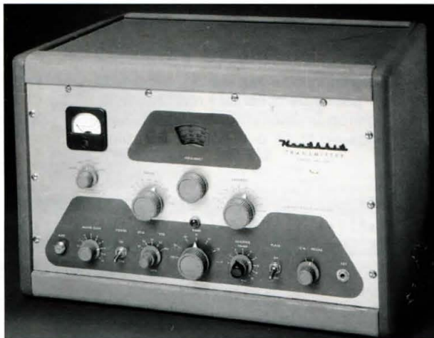
En la década de los cincuenta, este transmisor DX-100 de Heathkit y de precio asequible contribuyó a popularizar la AM entre los aficionados.
