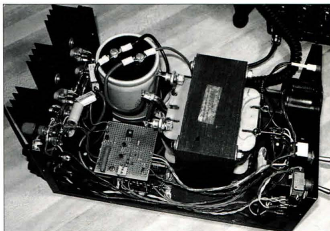
Foto B. Disposición interna de las piezas. Como puede verse, la mayor parte del alambrado lo es «al viejo estilo», punto a punto y solo algunos pequeños componentes están montados sobre un trozo de placa perforada.
