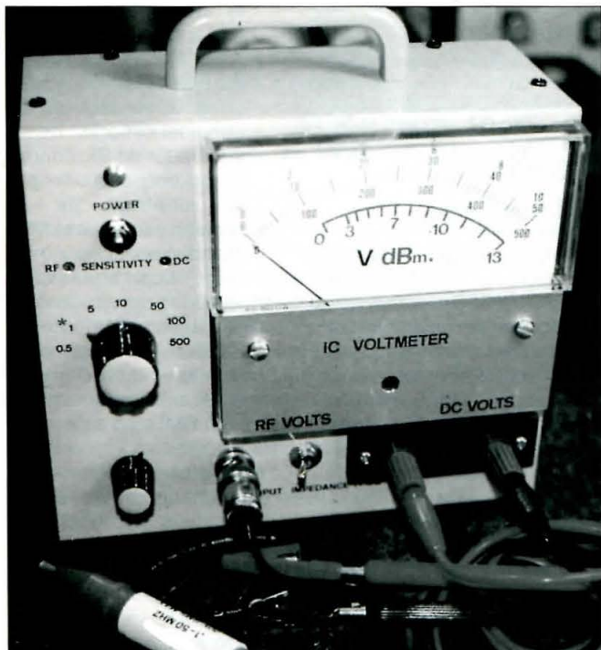
Foto 1. Visita exterior del voltímetro analógico para CC y RF de alta impedancia. Lo más destacable son las amplias escalas del instrumento. Obsérvese que hay una escala auxiliar de dBm, que se corresponde con la escala de 1 Vrms. La modalidad Vrms se entiende mediante sonda de RF. En primer término puede verse la sonda de RF tipo lápiz y el conector BNC para la entrada de señal. El interruptor de palanca situado a su derecha conmuta entre ambas entradas de señal, RF y CC.
