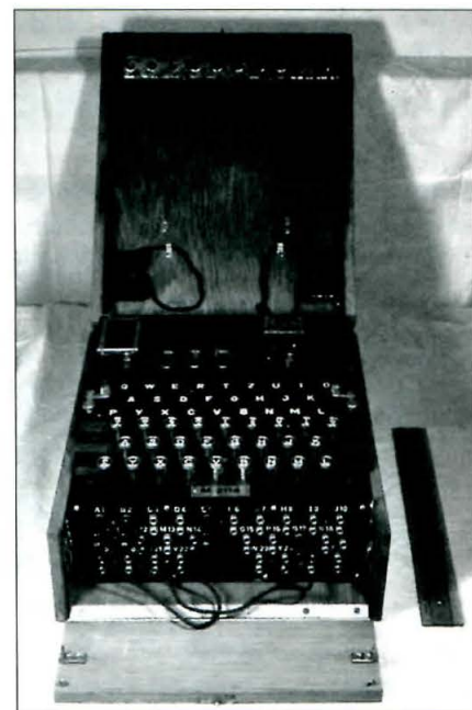
Foto A. Versión militar de la máquina Enigma, mostrando el panel delantero de transposición de letras o stecker. Obsérvese la carencia de teclas numéricas o de signos de puntuación.
