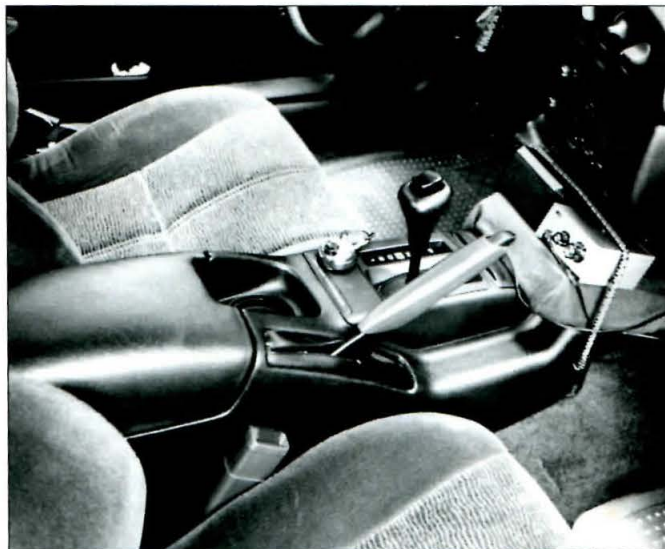
Foto B. ¡Moviéndose con estilo con QRP! Mi propio Chevrolet Camaro presenta un aspecto brillante y «de clase» con un MFJ Cub modificado para sacar 4 W, un sencillo altavoz de 5 x 10 cm y un pequeño manipulador vertical redondo.
