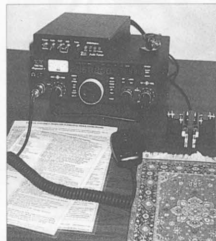
Foto D. Aquí vemos el Argonaut V con un tubo de goma quirúrgica negra cubriendo el alambre del soporte inclinado y una tira de goma blanca abrazando la periferia del mando de sintonía. Un sintonizador automático LDG Z11 ajusta bien encima. Sobre el mueble se adhieren bien unas palas iámbicas BullDog y al lado tenemos un Vibroplex Code Warrior. Las dos hojas plastificadas contienen la «chuleta» de operador. El micrófono de mano viene de dotación con el Argonaut V.
