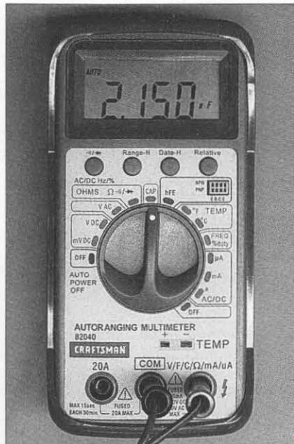
Foto C. Puede usarse un sencillo multímetro para medir la capacidad de un condensador SMD, utilizando las pinzas de prueba para SMD.
