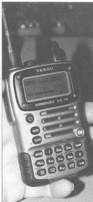
El VX-7R de Yaesu entrega 5 W en 6 m, 2 m y 70 cm (la versión americana también opera en 220 MHz) y tiene recepción simultánea en dos bandas a elegir.
