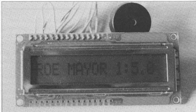
Foto D. El lectura total del medidor está limitada a un nivel de ROE máximo de 1:5.0, si se supera dicho valor la pantalla mostrará siempre el mensaje «ROE MAYOR 1:5.0».
