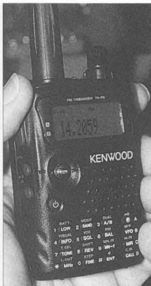
El TH-F6A es un portátil, cuya versión americana tribanda opera en 144, 220 y 430 MHz, permitiendo recepción bibanda simultánea, además de poder operar en dos frecuencias en la misma banda. A eso se añade la posibilidad de escuchar SSB y CW en onda corta, además de radiodifusión en AM.
