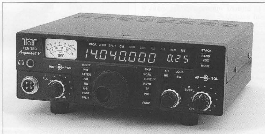
Foto A. El panel delantero del Argonaut V incorpora 12 teclas, dos mandos concéntricos, dos codificadores giratorios (incluyendo el mando de sintonía), un jack de auriculares, dos indicadores LED y una pantalla LED.
