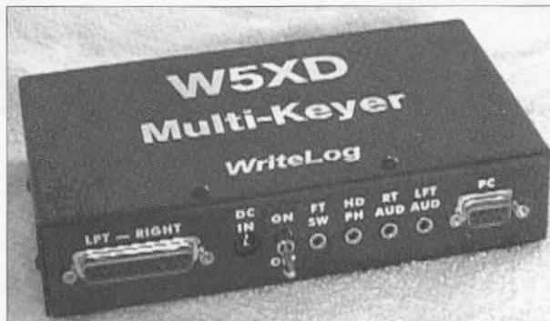
Figura 3. El «MK-1100 multi-function keyer» conecta nuestra radio a un ordenador vía un puerto serie y proporciona una serie de facilidades para el trabajo en concursos, especialmente en la modalidad de «dos radios» (SO2R).
