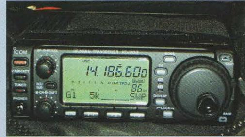
El IC-703 de Icom supone la entrada de la marca en el mercado de las radios «de mochila». El cabezal es separable e incluso se ofrece una mochila de la firma con bolsillos especiales, ranuras para pasar los cables además de una cubierta contra la lluvia.
