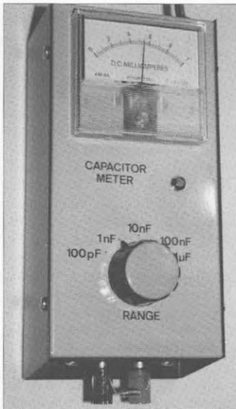
Foto A. Vista exterior del capacímetro. De abajo arriba, los bornes del condensador bajo prueba, el selector de los cinco márgenes de medición y el instrumento de cuadro móvil de 1 mA con escala lineal.
