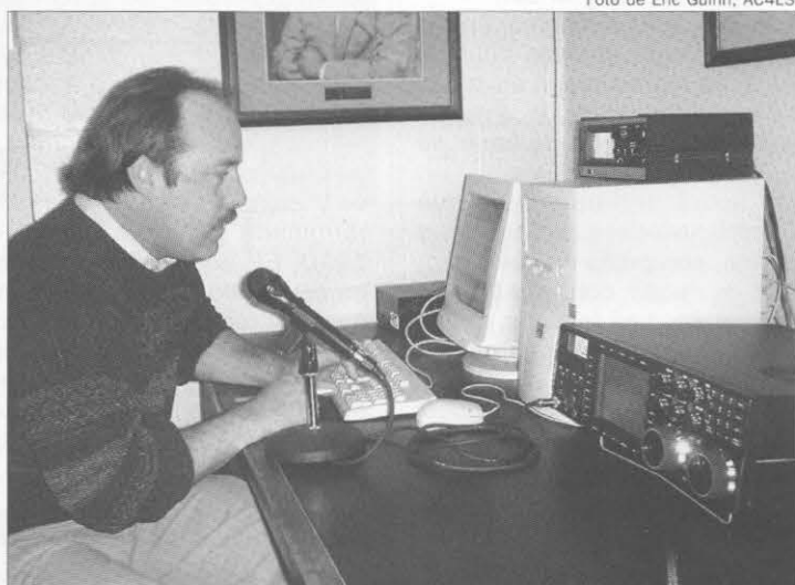
Foto A. Doug, KF6DX, realizando el primer contacto por voz digital de la historia en HF a larga distancia. Se emplearon transceptores Ten-Tec de serie, y ordenadores personales con el programa Skywave de Thales Communications.
