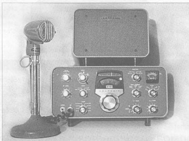
Foto C. Con mínimas modificaciones, incluso mi transceptor Heathkit SB-102 puede transmitir y recibir voz digital. Sobre todo, sería preciso reemplazar el filtro de 2,1 kHz de SSB (demasiado estrecho) por otro con un ancho de banda de al menos 2,5 kHz, preferentemente más de 2,5. El programa Skywave prefiere un ancho de banda de audio de 3 kHz (la mayoría de transceptores lo cumplen), aunque puede emplearse un ancho de banda ligeramente inferior si la señal está lo bastante por encima del ruido.
