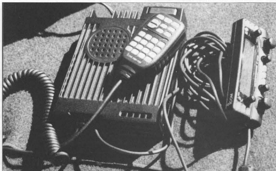
Uno de los ensayos del proceso de examen incluye una prolongada sesión de transmisión continua -sobre una carga artificial, por supuesto- para probar la efectividad del sistema de refrigeración. El informe señala que el IC-2720 pasó brillantemente esta prueba.
