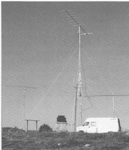
Vista general del puesto de concursos de Jordi, EA3EZG, y Paco, EA3FTT, en JN01x, con dos antenas 13B2 independientes para 144 MHz y una 13 WL para 432.
