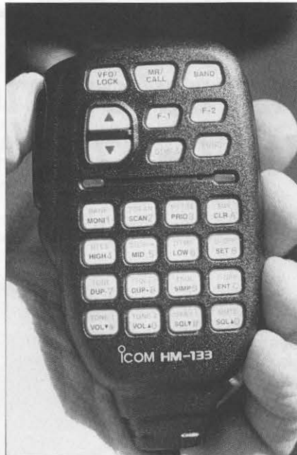
El micrófono estándar del IC-2720 viene con muchos botones, permitiendo controlar desde el mismo casi todas las funciones más importantes.
