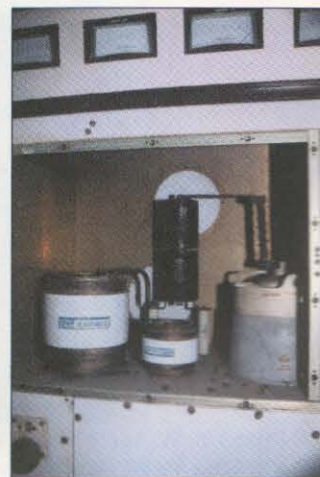
Ajustar un transmisor de varios kilovatios precisa un sistema de cargas fantasma de proporciones adecuadas, como estas Jennings para VHF.
