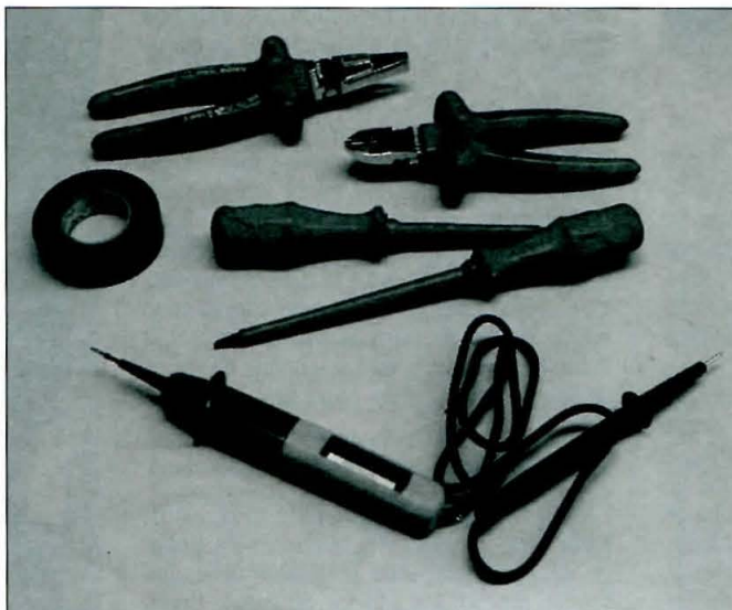
Si debemos trabajar en circuitos eléctricos de la instalación doméstica, hay que usar herramientas aisladas.
