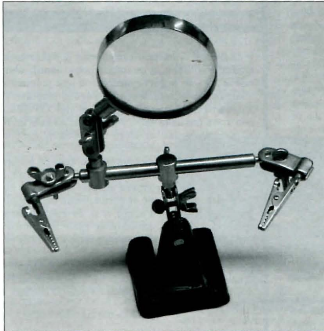
La fijación de las piezas a tratar puede facilitarse notablemente con esta práctico accesorio, que oficia de «tercera mano».
