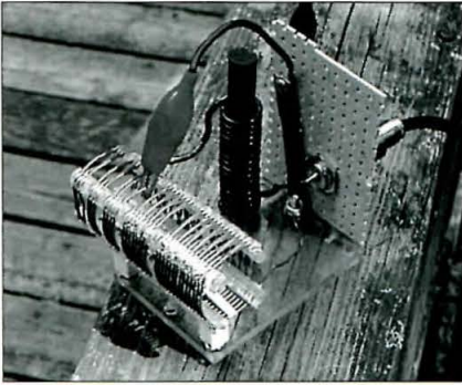
Foto B. Un inductor variable es una parte importante de las antenas cortas DCC.
