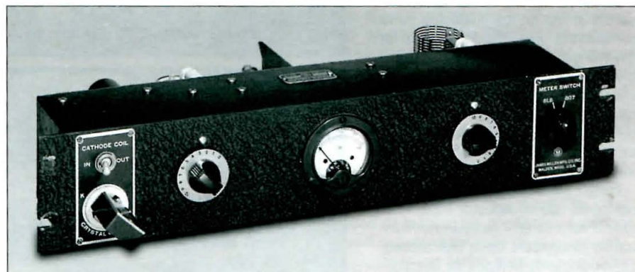
Transmisor Millen 90800. Este equipo de 1946 estaba dotado de una 6L6 y una 807 y es un ejemplo del diseño de anteguerra. La potencia de salida era de 50 W entre 80 y 10 metros.
