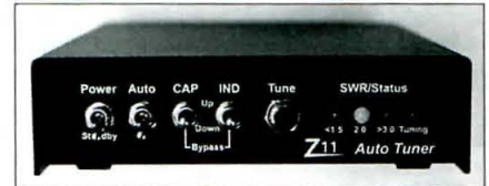
Foto 2. El popular y bien considerado acoplador automático de antena Z-11 de LDG mide 17,8 x 12,7 x 3,8 cm y es capaz de acoplar impedancias entre 5 y 800 Ω y funciona a 13 Vcc o con un par de pilas de 9 V para aplicaciones en el campo.
