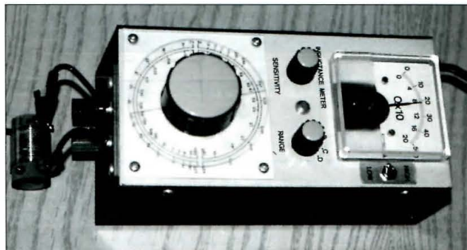
Foto A. Vista exterior, de izquierda a derecha: los bornes L, el mando del condensador variable C, a continuación el selector de escalas RANGE, el control de amplitud SENSITIVITY y el instrumento de cuadro móvil inductor de Q con el selector HIGH-LOW.
