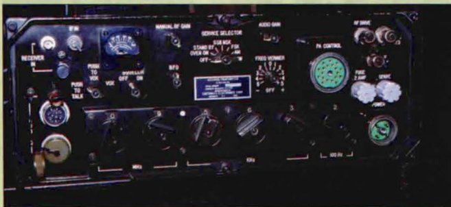
Equipo VRC12 (1-12 MHz, 100 W BLU) dotado de modulador para teletipo y alimentado a 24 V.
