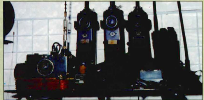
Equipos portátiles americanos, modelo 3PRC6, controlados a cristal de cuarzo. El margen de frecuencia de trabajo es de 30 a 50 MHz. Fabricados en el año 1960.
