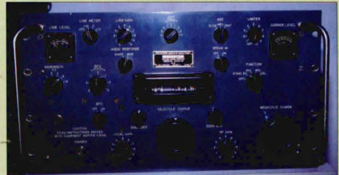
Receptor Collins URR-390, que cubre de 500 kHz a 32 MHz en sintonía continua. Dotado de filtros originales Collins. Alimentación, 220 Vca.
