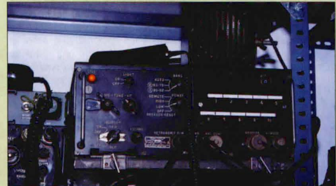
Transceptor VRC-524, que opera en FM entre 30 y 75 MHz en dos bandas (30-53 y 53-75) y con una potencia de 15 W.
