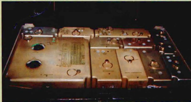
Vista interior del modelo PRC-47. Frecuencia: 1-14 MHz, USB. Potencia, 100 W alimentado a 24 V y dotado de sintetizador de frecuencia.
