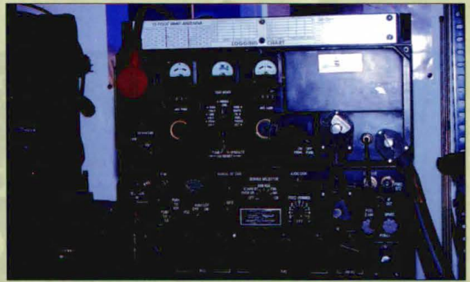
Equipo inferior: modelo VRC12, de 1 a 12 MHz BLU; equipo de ayuda al teletipo sintetizado, potencia 100 W alimentado a 24 V y equipado con válvulas. Equipo superior: amplificador lineal con dos válvulas CX-150, entrada 100 W, salida 400 W, alimentado a 24 V y utilizado exclusivamente para teletipo.
