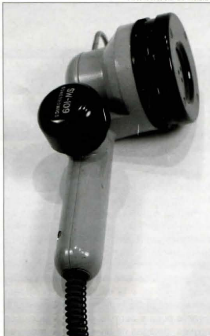
Foto G. Este modelo militar T17 hizo una extensa carrera en tanques, buques, aviones y coches de la policía de nuestro ayer y es la versión de mano del modelo «candelero», con un inequívoco pulsador PTT. Se utilizó ampliamente durante la época de la AM en móvil con transmisores a válvulas, convertidores Gonset y chirriantes dinamotres.
