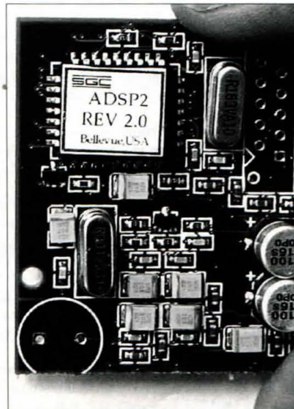
Foto B. La tarjeta Low Audio ADSP 2 está diseñada para ser instalada en el interior del SG-2020 y otros muchos receptores o transceptores.
