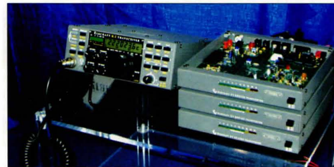
Los transversores para 6 m, 2 m y 222 MHz (EEUU) de Elecraft permiten operar en SSB y CW en VHF con el K2 u otro equipo similar.
