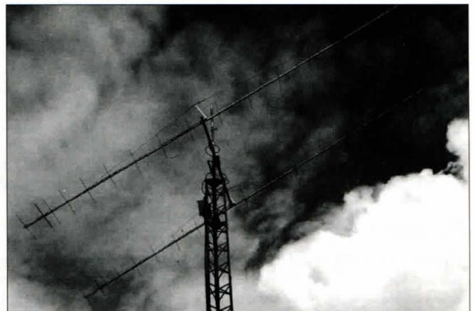
Las antenas apiladas horizontalmente ofrecen la ventaja de poder ser elevadas fácilmente para trabajar RL y satélites.
