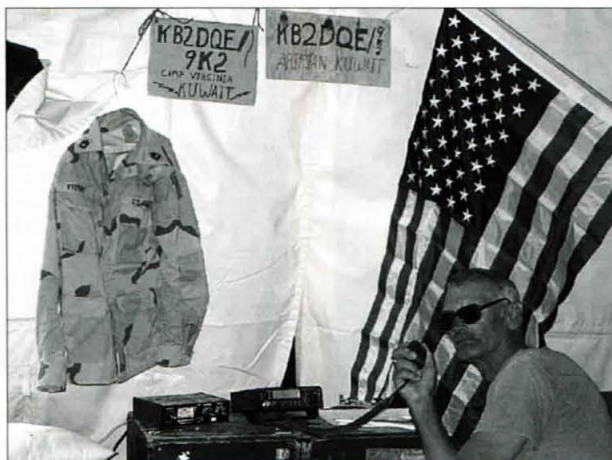
Jim, 9K2/KB2DQE, operando en una tienda en el desierto kuwaití. Usa un TS-50, un sintonizador móvil Hallicrafters y una V invertida para 40 metros. Nos dice que el viento del desierto ocasiona cargas estáticas y que tuvo que improvisar una «tierra» con un trozo de tubo clavado en el suelo. (Foto cortesía de KB2DQE)
