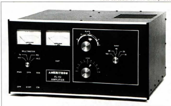
Foto A. Un apreciable número de amplificadores lineales modernos hacen uso de la configuración de rejilla a masa tanto para simplificar el diseño como su operación. El popular AL-82 de Ameritron es un buen ejemplo de ello. Usa un par de válvulas 3-500Z a polarización cero.
