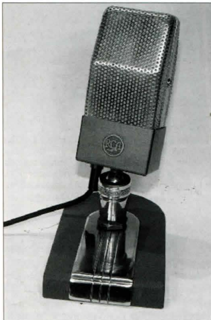
Foto C. RCA recobró su autoritaria posición en la radiodifusión y los estudios de grabación con su siempre popular micrófono Diamond 74B. Esta versión, más pequeña y menos cara que el 77D, ofrecía un perfecto balance en coste, aspecto y prestaciones. ¡Es un micro realmente espléndido!
