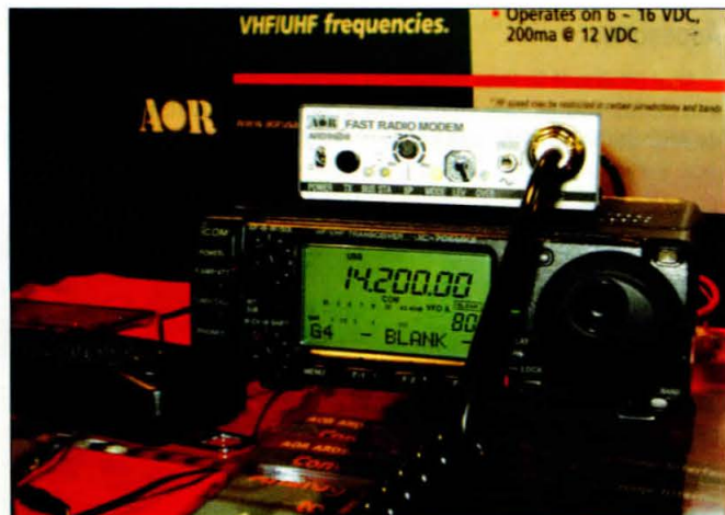
El «Fast Modem» ARD-9800 de AOR opera a través de las tomas de micrófono y altavoz para permitir que cualquier equipo pueda trabajar con modulación vocal digital, datos e imágenes, siempre con el ancho de banda típico de una señal de SSB.
