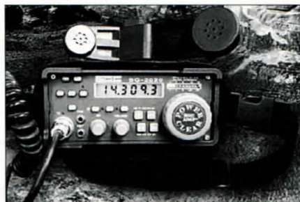
Foto A. El SG-2020 ADSP 2 funciona igual que el 2020 básico, excepto que el módulo interno ADSP 2 agrega atenuación de portadoras interferentes, capacidad de eliminación del ruido atmosférico y filtro pasabanda de audio.
