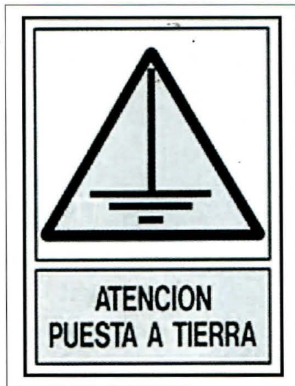
Figura 2. Los circuitos de puesta a tierra deben señalizarse adecuadamente.
