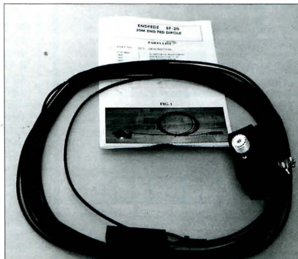
Foto A. La antena de media onda EndFed Z de PAR Electronics, tal como se la recibe, desempaquetada, y lista para funcionar. El conjunto comprende un radiador de Flexweave, una caja convertidora de impedancia con un conector SO-239 para la línea de alimentación y un librito de instrucciones. El hilo negro es apenas visible entre el follaje cuando está instalado en árboles.
