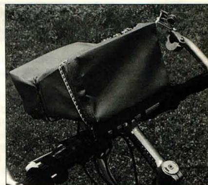
Foto 3. Una funda protectora casera protege al transceptor de las inclemencias del tiempo o cuando se circula por caminos polvorientos. El equipo se alimenta con una batería interna, mientras en una de las alforjas laterales se aloja una batería de repuesto.
