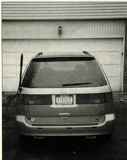
Foto 6. La vista trasera del auto de K2ACB muestra la antena multibanda ATAS de Yaesu. Su mástil está soportado por un ángulo de montaje K-400 de Diamond en el borde del maletero y todo parece casi que sea parte natural del diseño del coche. ¡Bonito y poco aparatoso!
