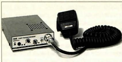
Fig. 1. Módem AOR ARD9800 para voz digital.
