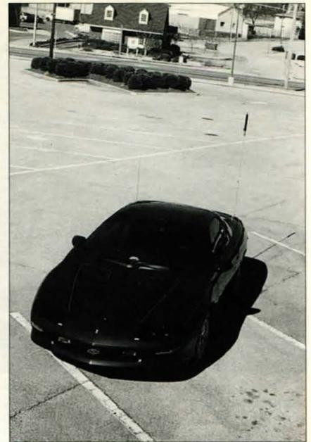
Foto 8. Amigos, vean la versión extra larga de la antena móvil MP1 de W6MMA montada en mi Camaro del 96. Funciona entre 40 y 10 metros, mide 4,04 m desde su extremo hasta el suelo y saca una señal «matadora».
