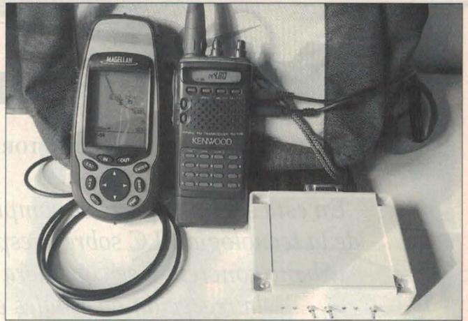
Foto C. Una instalación portable de APRS. La información de posición procedente del receptor GPS, codificada por el PicM, se difunde como señal APRS a través de un transceptor portátil.
