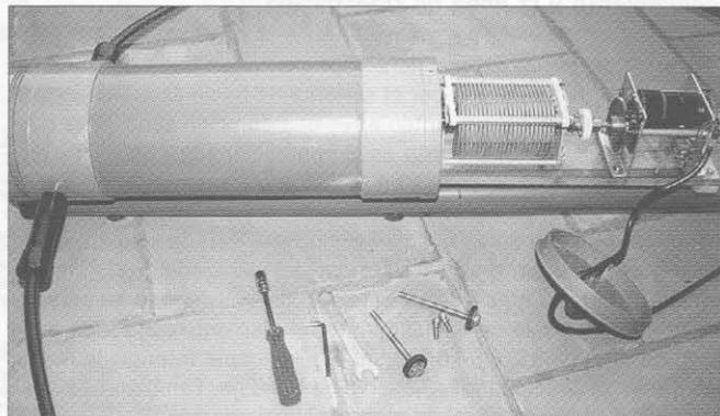
Foto B.- Detalle del conjunto de sintonía de la antena de aro para 80 metros. Vista en un primer plano del condensador variable de 488 pF / 2000 V cuyo rotor está unido mecánicamente por un separador axial, y aislante de la RF con el motor-reductor.
