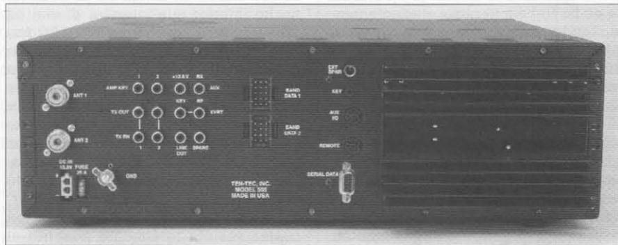
Vista trasera del Orion. Adviértanse los conectores dobles de salida, que permiten al usuario no solo conmutar antenas, sino manejar algunos parámetros pulsando una tecla del panel frontal (Foto Ten-Tec)
