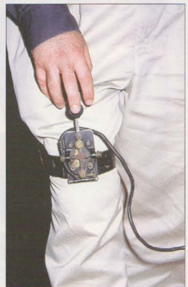
Manipulador militar que se ponía en la rodilla para ir manipulando mientras se viajaba en un vehículo.
