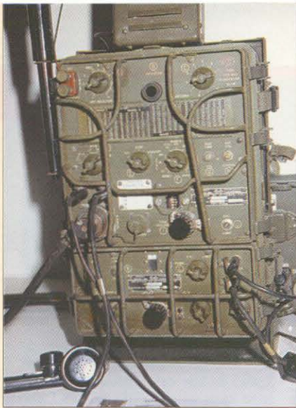
Transmisor francés con antena telescópica de más de 2 metros de altura y que se llevaba a la espalda
