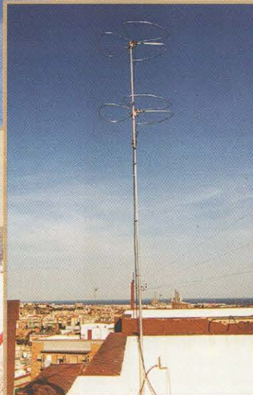
Una «doble molinete», a buena altura y despejada, es una ayuda inestimable en los concursos de VHF, pues permite explorar señales de SSB en todas direcciones, sin la pérdida de tiempo y oportunidades que supone el girar una gran directiva.
