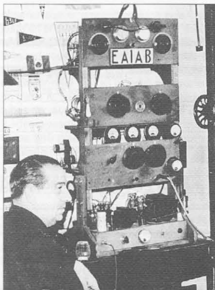
Hacia 1959 se precisaba una considerable dosis de habilidad e imaginación para ser radioaficionado. Este "rack" de Javier de la Fuente, EA1AB, contenía un transmisor de 50 W, AM de construcción casera.
