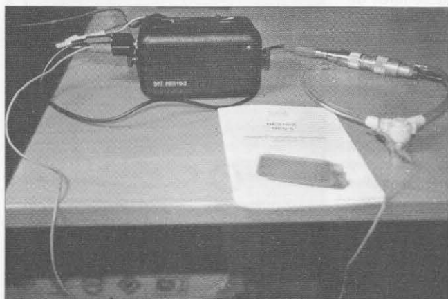
Foto B. La toma de auricular del NES10-2 permite escuchar «en silencio» y -con la ayuda de un adaptador en Y- tomar una muestra de la señal y llevarla a un osciloscopio para efectuar medidas.
