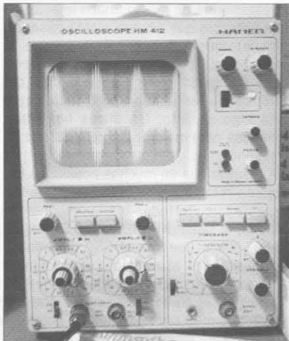
Foto C. Imagen de una señal impulsiva interfe-rente, de aproximadamente 14 dB en tensión (o sea 25 veces en potencia) por encima de la modulación de una estación, y que reduce casi a cero la inteligibilidad.
